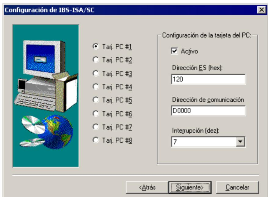
Figura 10 Configuración de IBS-ISA/SC
