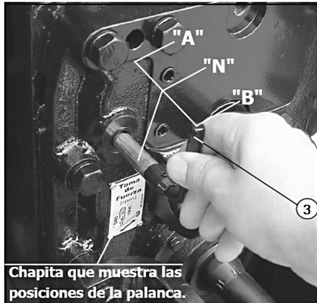
\* Colocando la palanca hacia adelante (Pos. A), con el motor a 2077 rpm, se obtiene 1000 rpm
