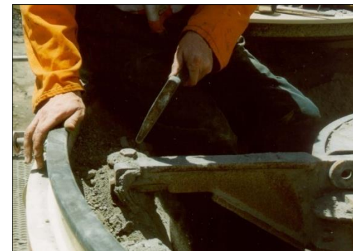
Quite el acumulación de los tornillos.
