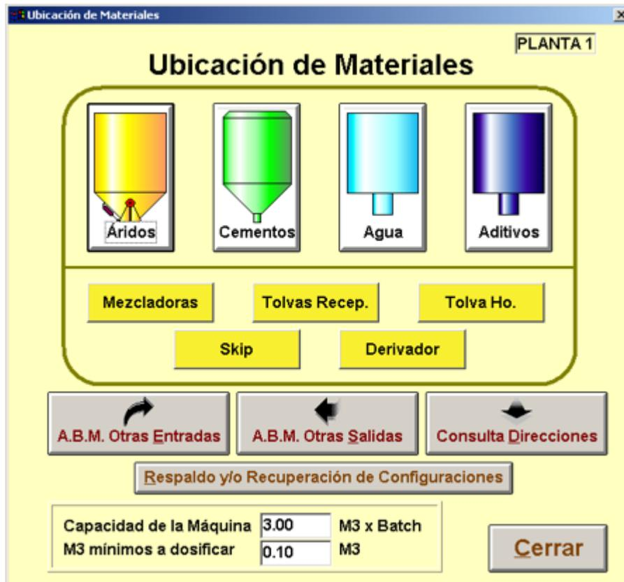
Permite determinar los parámetros de carga, es decir, la ubicación física de los materiales en los silos y la cantidad de balanzas existentes por familia. Cabe aclarar que para realizar esto es preciso basarse en la Configuración general del sistema.
