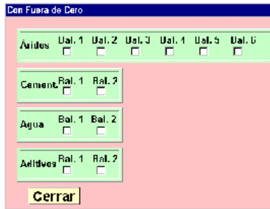
En el caso que quedara material en una balanza se podrá iniciar el ciclo de todas maneras a responsabilidad del operador con clave de acceso. Para esto se supondrá que la balanza está correctamente acerada y se tomará como referencia el último auto cero efectuado. Debido a que no se puede saber en una balanza por suma cuál o cuales son los materiales que en ella están presentes quedará asentado junto con el remito correspondiente los kilos aceptados.
