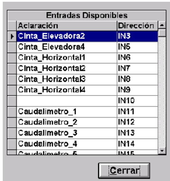
Permite ingresar las señales de entrada que no están contempladas en otros puntos de la configuración de la máquina; por ejemplo el modo de dosificación automático/manual, finales de carrera, cintas, removedores, sensor de presión, sensores de mínima y máxima, alarmas y otros accionamientos varios.
