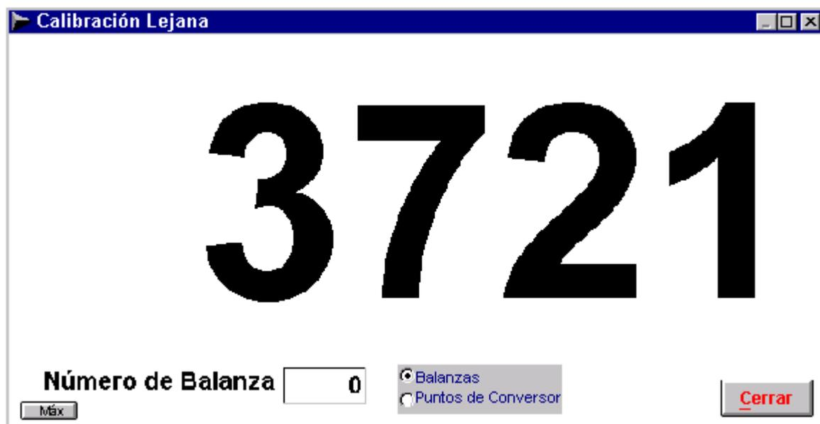
Permite ver una balanza o su valor en puntos de conversor para facilitar la Calibración desde un punto lejano. Si se precisa ver el monitor desde una posición alejada, el botón "Máx" amplía el valor que se muestra en la pantalla para tener una mejor visión de la misma.
