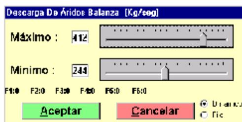
Permite ajustar el flujo en la descarga de la balanza de áridos en tiempo real (tiempo de ejecución del ciclo) ajustando el valor máximo y mínimo de kilogramos por segundo.
