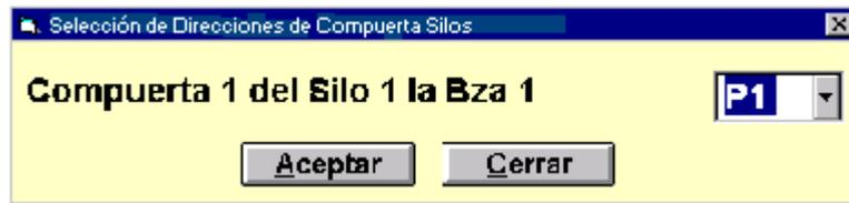
Permite asignar una dirección específica y única a cada una de las compuertas de los silos. Una pantalla similar se presenta para el direccionamiento de los vibradores, los canales analógicos y las compuertas de las balanzas.
