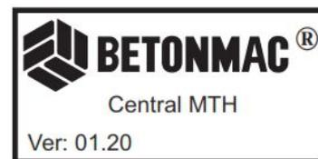
Durante el arranque el equipo realiza una verificación de estado del mismo, y si existiera error alguno se indicará en este momento, pudiéndose leer en el display el código de error y una breve explicación de la falla. Pueden presentarse fallas que no sean detectadas automáticamente por la central, ante esta situación comuníquese con el soporte técnico de Betonmac S.A.
