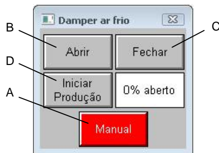
Fig. 63: Damper del aire frío / Damper de l'air froid
