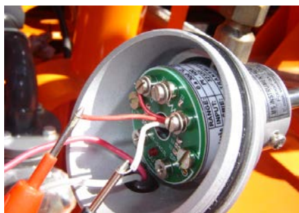
Fig. 3: Verificação da resistência do PT100 / Verificación de la resistencia del PT100 / Checking the resistance of PT100 / Vérification de la résistance du PT100
