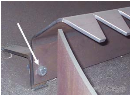
Fig. 29: Retirada das aletas do secador / Retirada de las aletas del secador / Removing drum flights from the dryer / Extraction des ailettes du sécheur
