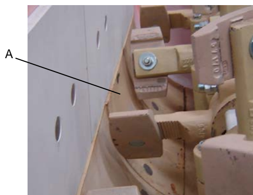
Fig. 2: Folga da palheta / Clearance of the paddle /
