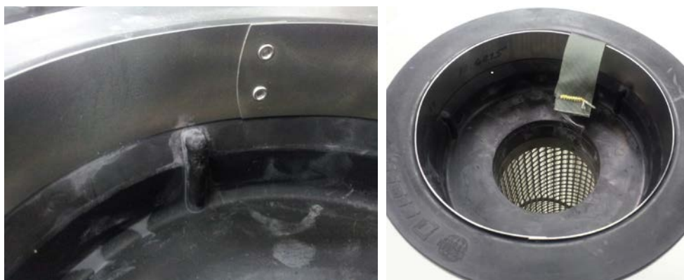
Fig. 7: Snap-Band aplicado no topo emborrachado das mangas / Snap-Band aplicado en el tope engomado de las mangas / Snap-Band applied on the bag's rubber top / Snap-Band sur l'extrémité supérieure en caoutchouc des poches
