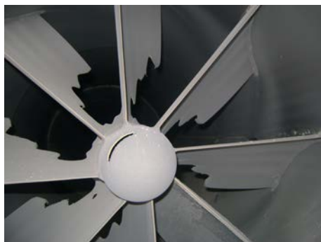
Fig. 7: Desgaste avançado das aletas / Advanced wear of the blades
