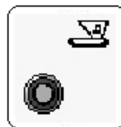
Fig. 22: Potenciômetro de controle de velocidade da correia dosadora do silo 5 (Opcional) / Potenciómetro de control de velocidad de la cinta dosificadora del silo 5 (Opcional) / Potentiometer for controlling the dosing belt's speed for bin 5 (Optional) / Potentiomètre de contrôle de vitesse de la courroie de dosage du silo 5 (Optionnel)
