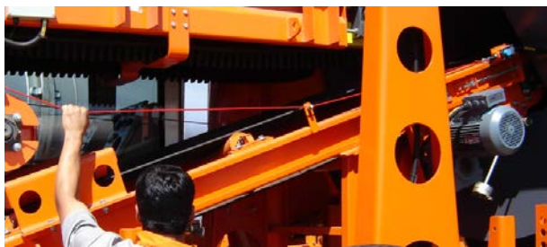
Fig. 9: Cabo de segurança lateral / Cable de seguridad lateral / Side emergency pull string / Câble de sécurité latéraux
