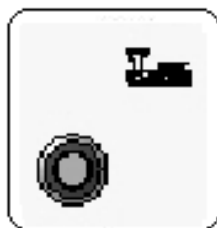
Fig. 25: Potenciômetro de controle da velocidade do caracol dosador de finos (Opcional) / Potenciómetro de control de la velocidad del caracol dosificador de finos (Opcional) / Potentiometer for controlling the screw conveyor speed on the fine aggregates feed bin (Optional) / Potentiomètre de contrôle de vitesse du transporteur à vis sans fin de dosage de fines (Optionnel)
