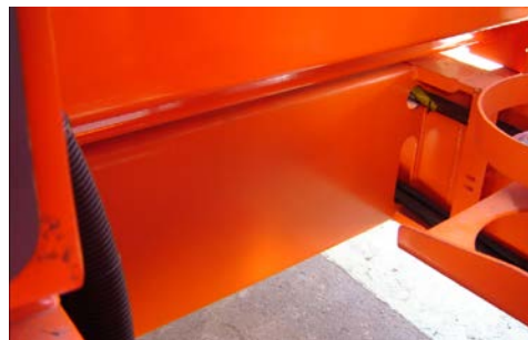
Fig. 19: Viga para medición próxima al mezclador / Poutre de mesure près du malaxeur
