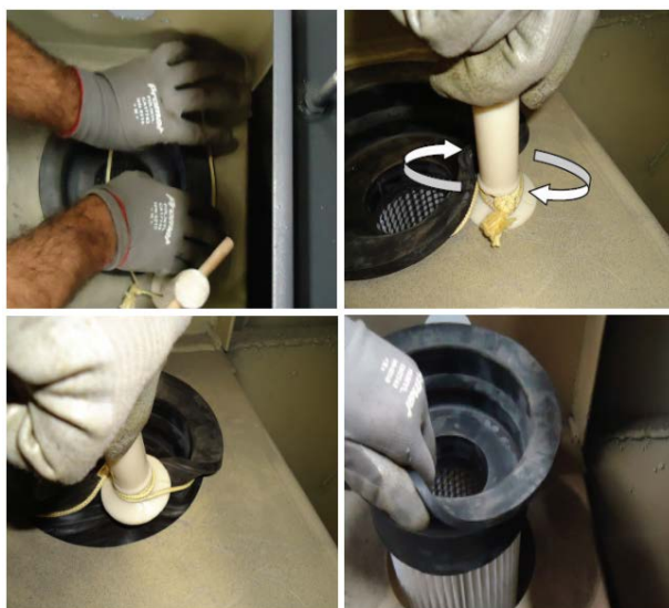
Fig. 10: Forma de utilização do Easy-Spin para retirar a manga da chapa espelho / Forma de utilización del Easy-Spin para retirar la manga de la plancha espejo / Use of Easy-Spin to remove the bag from the mirror plate / Mode d'utilisation de l'Easy-Spin pour retirer la poche de la plaque miroir
