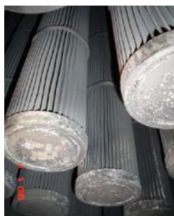
Fig. 2: Mangas contaminadas por óleo / Mangas contaminadas por aceite / Bags contaminated by oil / Manches contaminées d'huile
