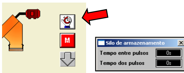
Fig. 51: Ajuste do tempo de abertura da comporta em modo automático / Ajuste del tiempo de abertura de la compuerta en modo automático / Adjusting the time that the flow gate stays open in automatic mode / Réglage du temps d'ouverture de la vanne au mode automatique
