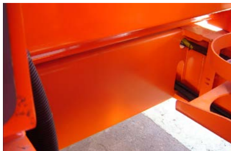
Fig. 17: Viga para medição próxima ao misturador / Beam for measuring close to mixer
