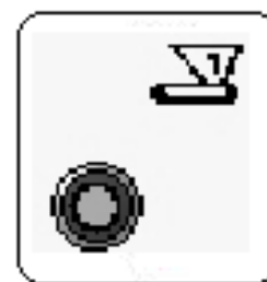
Fig. 18: Potenciômetro de controle de velocidade da correia dosadora do silo 1 / Potenciómetro de control de velocidad de la cinta dosificadora del silo 1 / Potentiometer for controlling the dosing belt's speed for bin 1 / Potentiomètre de contrôle de vitesse de la courroie de dosage du silo 1
