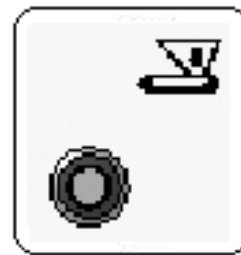
Fig. 20: Potenciômetro de controle de velocidade da correia dosadora do silo 3 / Potenciómetro de control de velocidad de la cinta dosificadora del silo 3 / Potentiometer for controlling the dosing belt's speed for bin 3 / Potentiomètre de contrôle de vitesse de la courroie de dosage du silo 3
