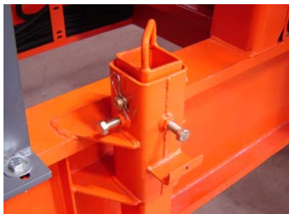
Fig. 2: Regulagem superior dos pés de apoio / Top adjustment of the support feet
