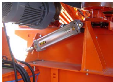
Fig. 61: Posición de transporte del cilindro neumático / Position de transport du cylindre pneumatique
