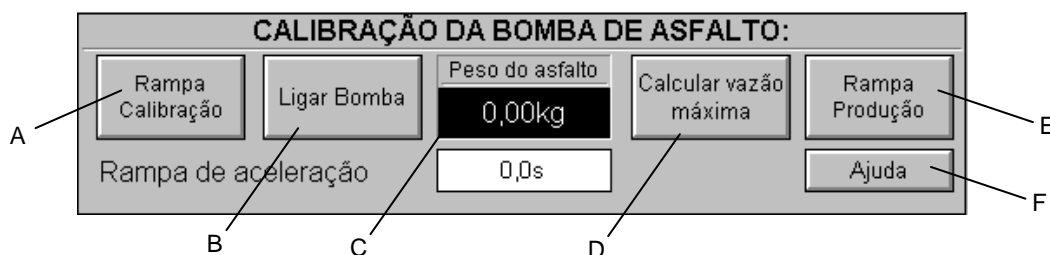
Fig. 5: Calibração da bomba de asfalto / Calibrating the asphalt pump
