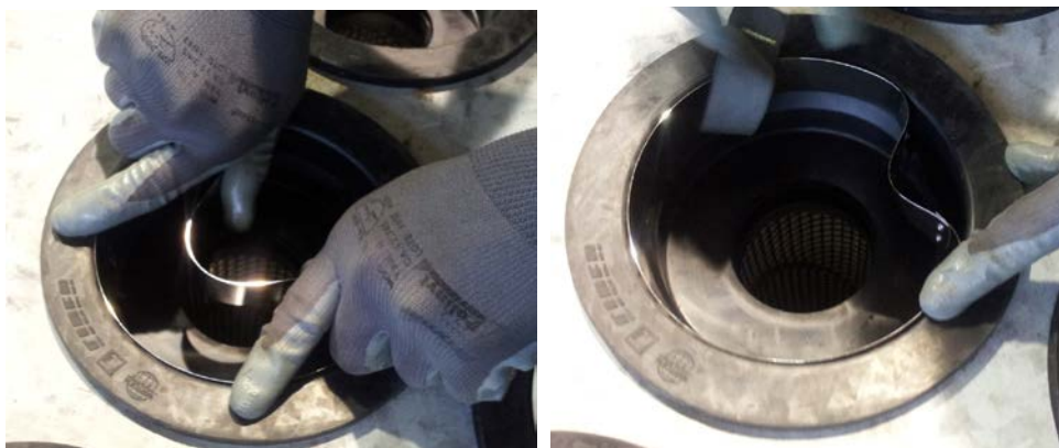
Fig. 6: Fixação do Snap-Band no interior do topo emborrachado da manga / Fijación del Snap-Band en el interior del tope engomado de la manga / Fixing Snap-Band at the inside of the bag's rubber top / Fixation du Snap-Band à l'intérieur de l'extrémité supérieure en caoutchouc de la poche
