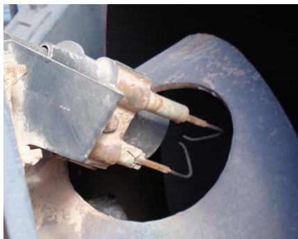
Fig. 9: Posicionamento dos eletrodos de ignição / Posicionamiento de los electrodos de ignición / Positioning the ignition electrodes / Position des électrodes d'allumage
