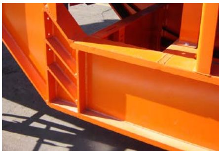
Fig. 6: Ponto de medição próximo ao pino rei / Measuring point close to king pin
