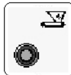
Fig. 21: Potenciômetro de controle de velocidade da correia dosadora do silo 4 (Opcional) / Potenciómetro de control de velocidad de la cinta dosificadora del silo 4 (Opcional) / Potentiometer for controlling the dosing belt's speed for bin 4 (Optional) / Potentiomètre de contrôle de vitesse de la courroie de dosage du silo 4 (Optionnel)
