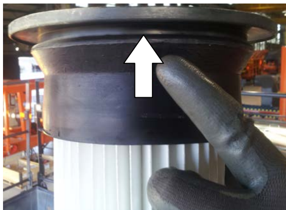
Fig. 4: Indicação da região de encaixe na chapa espelho / Indicación de la región de encaje en la plancha espejo / Indication of the fitting region on the mirror plate / Indication de la zone de fixation sur la plaque miroir
