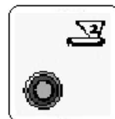
Fig. 19: Potenciômetro de controle de velocidade da correia dosadora do silo 2 / Potenciómetro de control de velocidad de la cinta dosificadora del silo 2 / Potentiometer for controlling the dosing belt's speed for bin 2 / Potentiomètre de contrôle de vitesse de la courroie de dosage du silo 2
