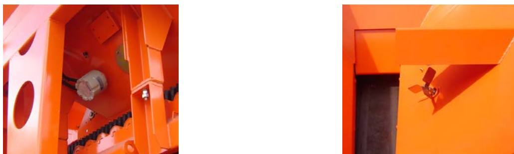
Fig. 5: Sensor de nível mínimo de agregado / Sensor de nível mínimo de árido / Minimum aggregate level sensor / Capteur de niveau minimum d'agrégat
