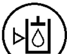
**Comprobación del nivel de aceite hidráulico** - Compruebe el nivel de aceite hidráulico en la mirilla cada diez horas de servicio o al final de cada día.
