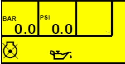
El LCD también muestra la exacta naturaleza de cualquier condición de alarma que haya ocurrido, tal como **Baja presión de Aceite** usando el icono apropiado. Esto permite una condición de alarma específica que llamará la atención del operador. Refiérase a la sección **Protecciones** de este manual para detalles de las alarmas.
