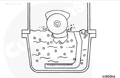
El bajo nivel del aceite **no** aparecerá normalmente como baja presión de aceite. Típicamente, aparecerá como una pérdida intermitente de presión de aceite cuando se da vuelta a una esquina o se opera en una pendiente pronunciada. Esta condición existe cuando el nivel del aceite es extremadamente bajo y el tubo de succión **no** puede tomar aceite durante todos los modos de operación.
