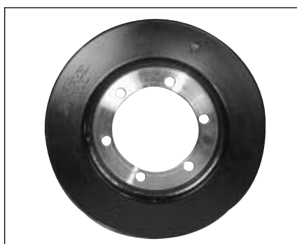
6 barrenos de montaje
