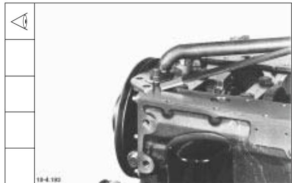
144. Fugen der Ölwanne dichtfläche mit **Deutz DW 47** auffüllen.
