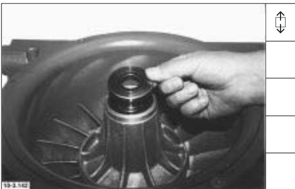
4. Druckventil einsetzen.
