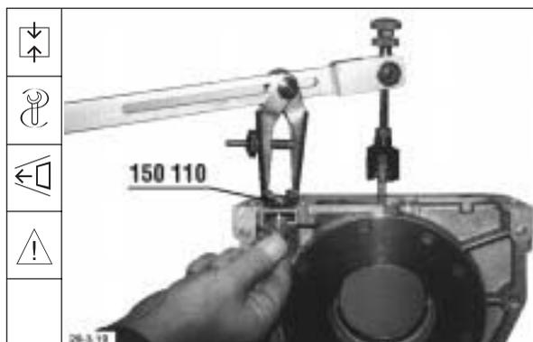
7. Wellendichtring mit Montagevorrichtung montieren.
