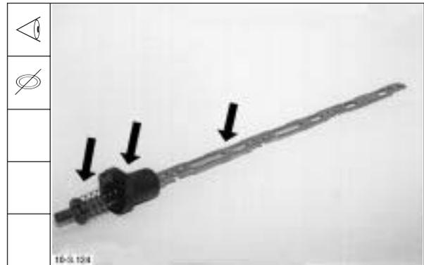
2. Führungsbuchse am Spannstift aufbohren und entfernen.
