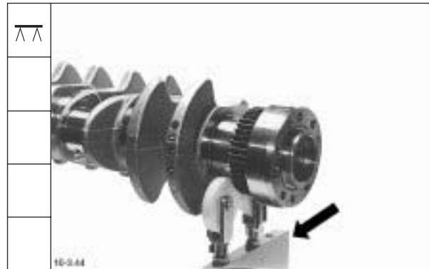
2. Schema zum Vermessen der Hauptlagerzapfen an den Stellen "1" und "2" in der Ebene "a" und "b".
