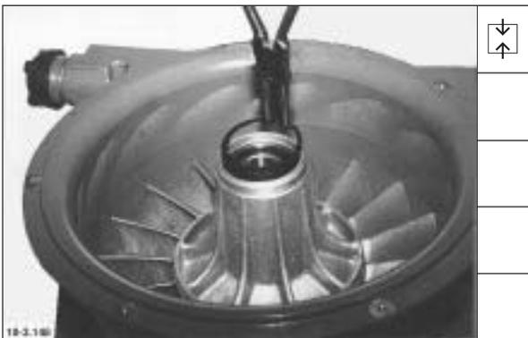
13. Sicherungsring montieren.
