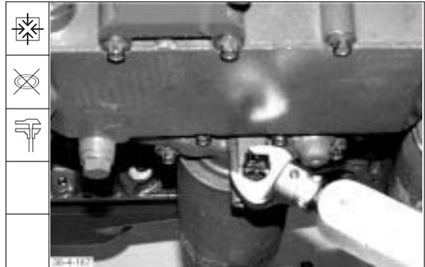
31. Kühlmitteltemperaturgeber mit neuem Cu-Ring anbauen und mit einem Drehmoment von **18 ± 2 Nm** festdrehen.
