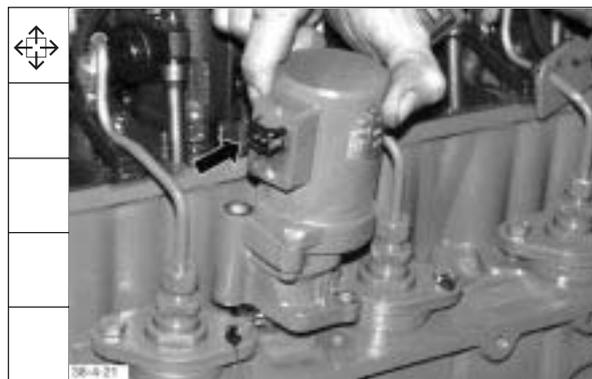
3. Regelstange mittels Abstellhebel in Stopstellung drücken. Andrückvorrichtung einsetzen und verschrauben.
