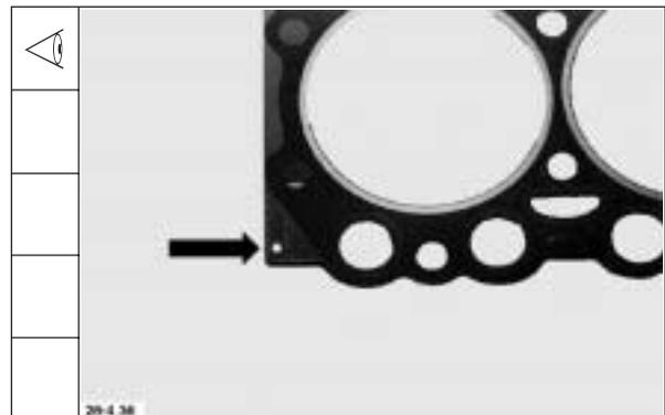
98. Zylinderkopfdichtung auflegen.
