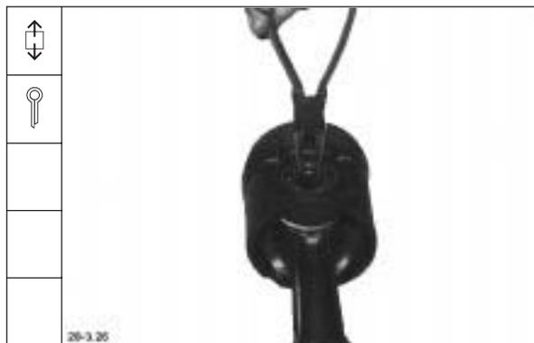
2. Kolbenring-Auflegezange auf den Kolbendurchmesser einstellen. Kolbenringe abbauen.
