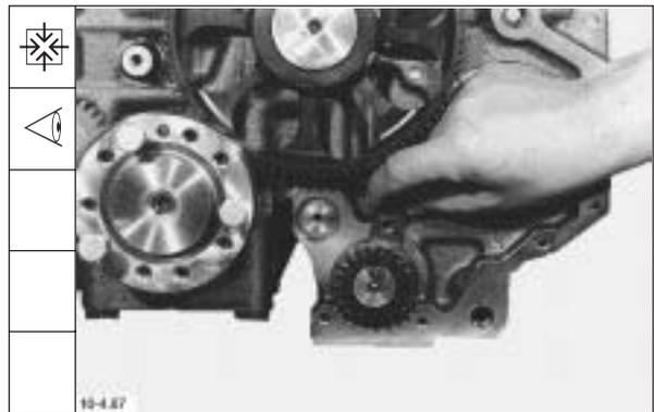
33. Schraube mit einem Drehmoment von **29 Nm** festdrehen.
