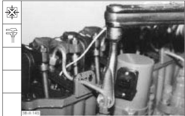
119. Leckölleitung anbauen und durch Dichtgummis einführen.
