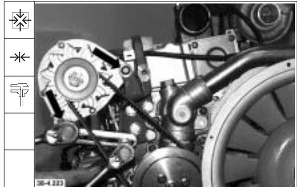
47. Keilriemenspannung mit Spannungsmeßgerät prüfen.
