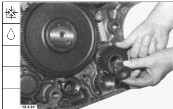
40. Schraube einsetzen und mit einem Drehmoment von **21 Nm** festdrehen.
