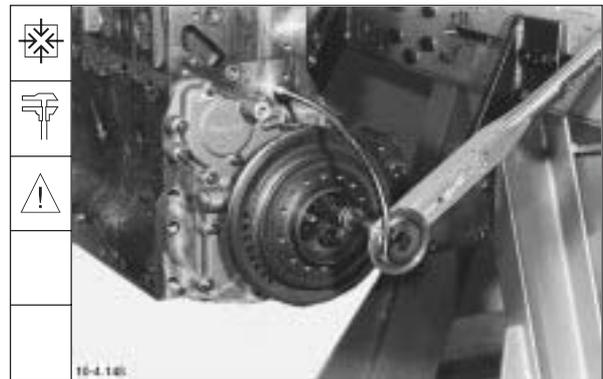
**Hinweis:** Torx-Steckschlüssel E20 verwenden. Schrauben können bei Nachweisbarkeit max. **5x** wiederverwendet werden.
