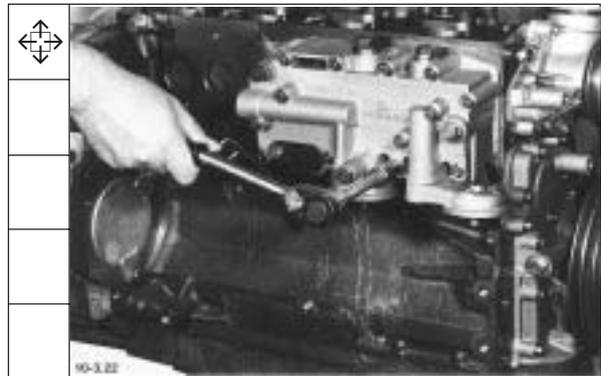
22. Kühlmittelpumpe mit Thermostatgehäuse abbauen.
