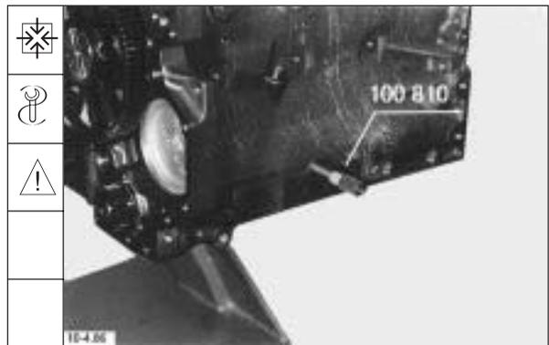
32. Anlaufscheibe anbauen und zur Wellenachse ausrichten.
