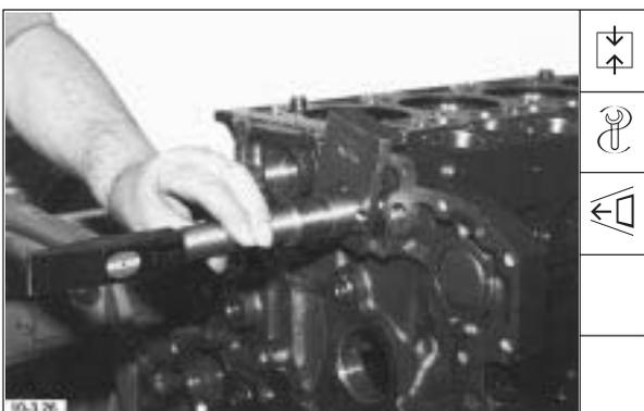
27. Bei BF6M Motor Führungsbuchse schwungradseitig wie Pos. 23-26, jedoch mit langem Montagedorn, eintreiben.
