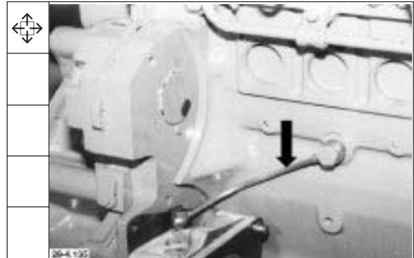
2. Hydraulikpumpe abbauen.
