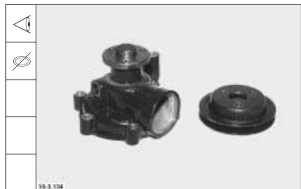
3. Keilriemenscheibe montieren. Schrauben mit einem Drehmoment von **21 Nm** festdrehen.
