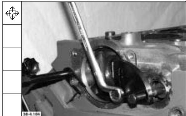
86. Von Vorrichtung bis zur Stopstellung der Regelstange messen.
