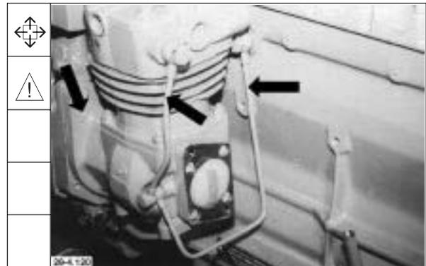
2. Neuen Runddichtring montieren.
