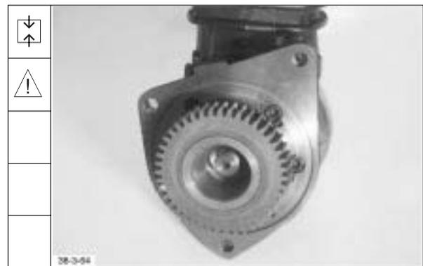
4. Gegenhalter auf Zahnrad aufschieben und Befestigungsmutter mit einem Drehmoment von **200 + 50 Nm** festdrehen.
