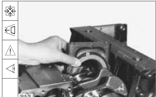
16. Hauptlagerdeckel entsprechend der Numerierung montieren.
