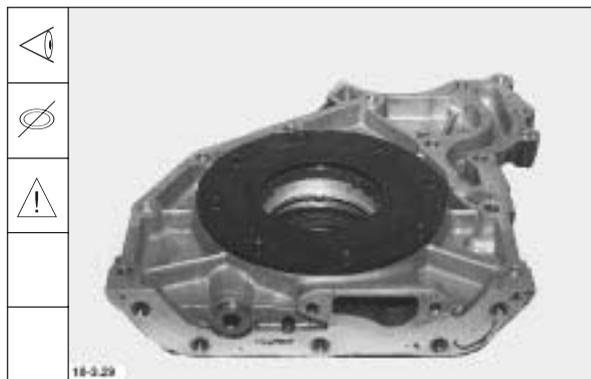
3. Zum Reinigen des vorderen Deckels Schmierölpumpe und Druckregelventil ausbauen.
