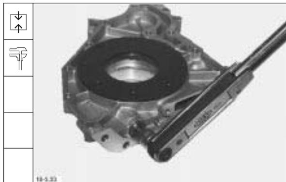
6.1 Druckregelventil BFM 1013 einbauen:
