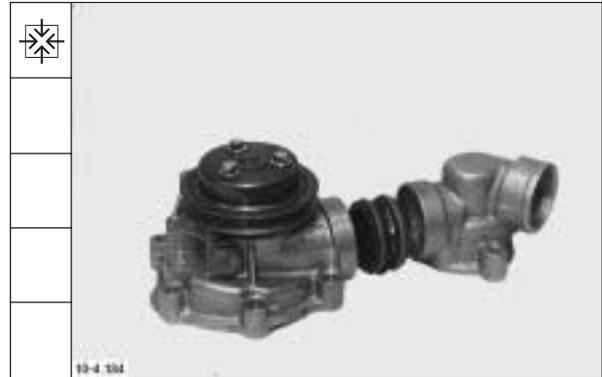
135. Neuen Runddichtring in Thermostatgehäuse einsetzen.
