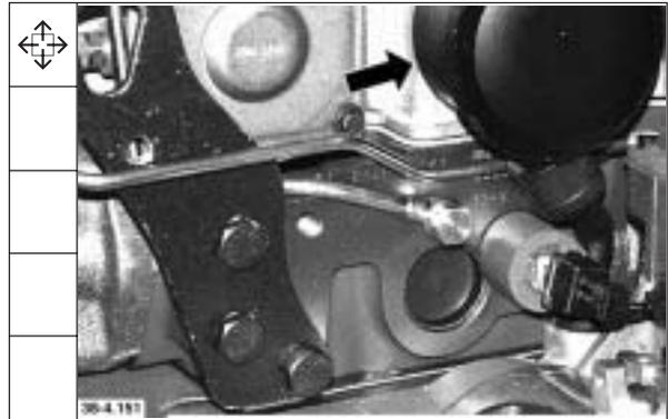
13. Luftleitung zum LDA und Entlüftungsleitung abbauen.
