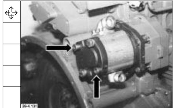
2. Schrauben von Führungsflansch heraus-schrauben.
