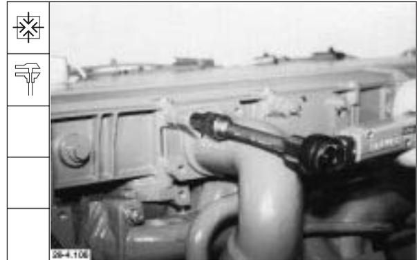
205. Falls vorhanden, Öleinfüllstutzen mit neuer Dichtung anbauen und mit einem Drehmoment von  $21 \pm 2$  Nm festdrehen.
