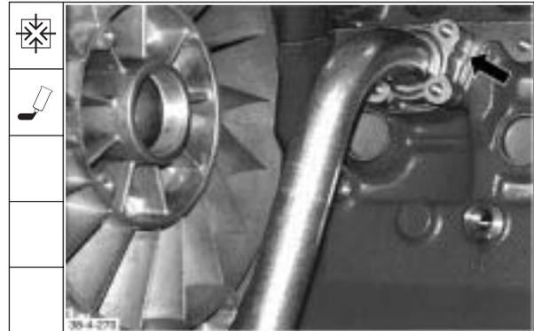
56. Schrauben mit einem Drehmoment von **28 Nm** festdrehen.
