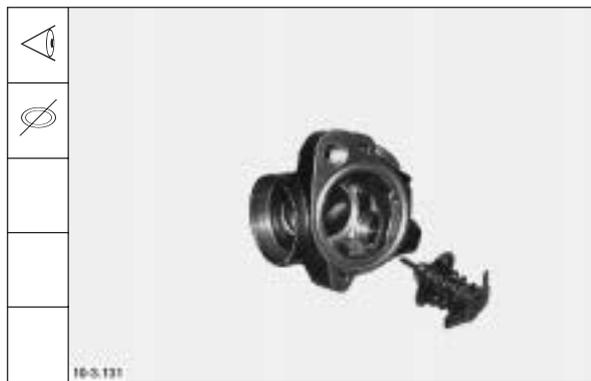
3. Thermostat niederdrücken und in Thermostatgehäuse hineindrehen.
