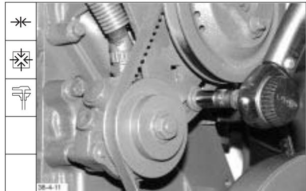
213. Keilriemenspannung mit einem Spannungsmeßgerät prüfen.
