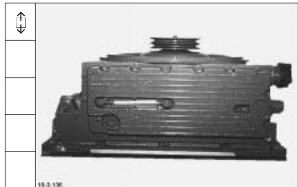
2. Sicherungsring für Druckventil herausnehmen. Druckventil ausbauen.
