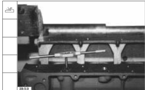
30. Ausziehvorrichtung einschrauben und Druckhalteventil herausziehen.
