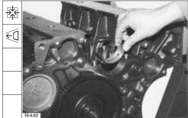
7. Lagerschalen in Hauptlagerdeckel einsetzen.
