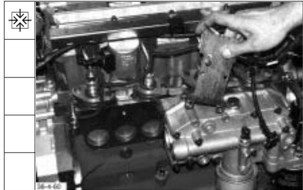
33. Befestigungsschrauben mit einem Drehmoment von **21 ± 2 Nm** festdrehen.
