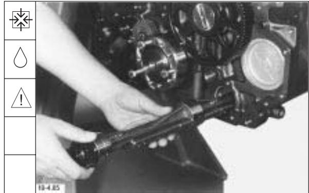
31. Einstellbolzen für Massenausgleichswelle in das Kurbelgehäuse bis zum Anschlag einschrauben.
