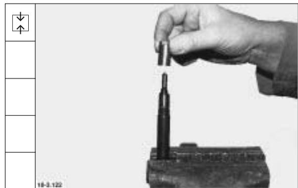
11. Überwurfmutter mit einem Drehmoment von **40 - 50 Nm** festdrehen.
