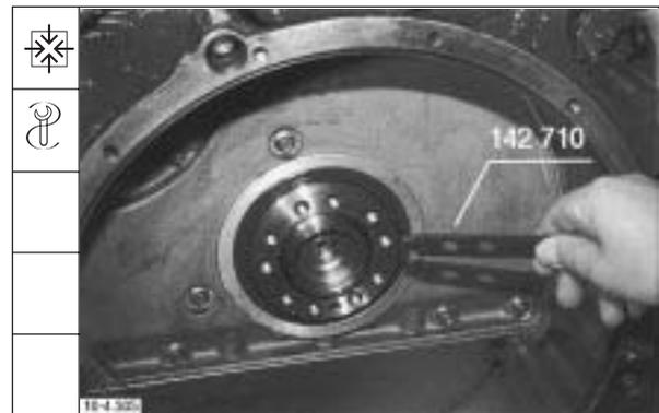
2. Wellendichtring mit Ausziehvorrichtung aus dem Räderkastendeckel hebeln.
