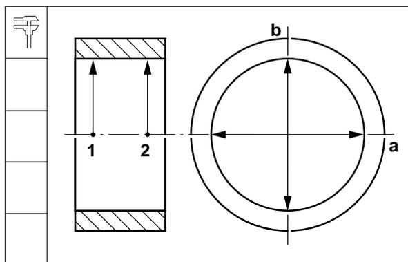
11. Entsprechen die Messungen den angegebenen Werten, ist nach dem Einbau von Lagerschalen die Vorspannung vorhanden.
