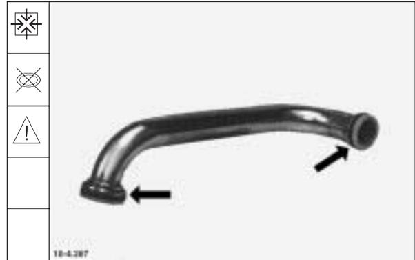
54. Kühlmittelrohr mit Flansch vormontieren.
