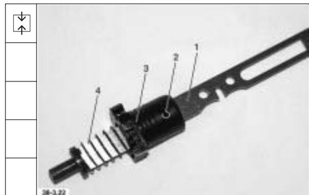
4. Einbauichtung der Regelstange zur Führungsbuchse beachten.
