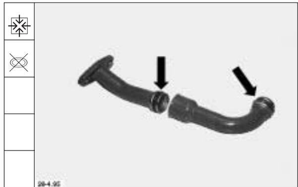
191. Rücklaufrohr mit neuer Dichtung an-bauen.
