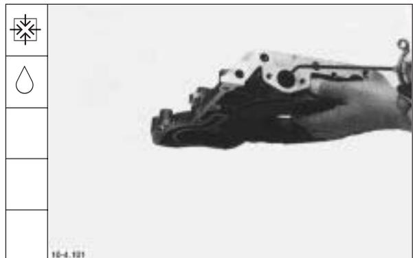
47. Dichtung für vorderen Deckel mit etwas Fett ankleben.
