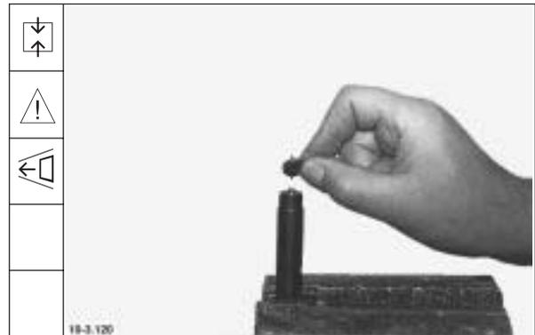
9. Einspritzdüse mit den Zentrierbohrungen auf die Zentrierstifte des Zwischenstückes aufsetzen.
