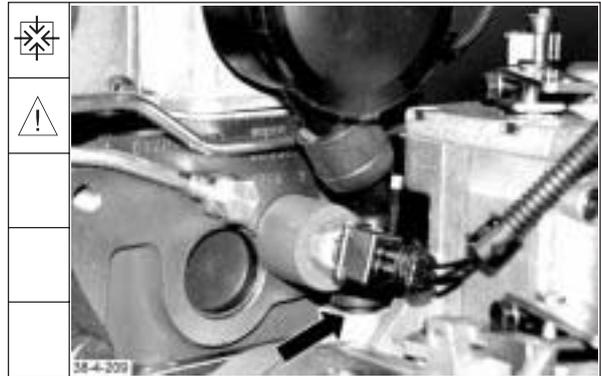
175. Schrauben mit einem Drehmoment von **8,5 ± 1 Nm** festdrehen.
