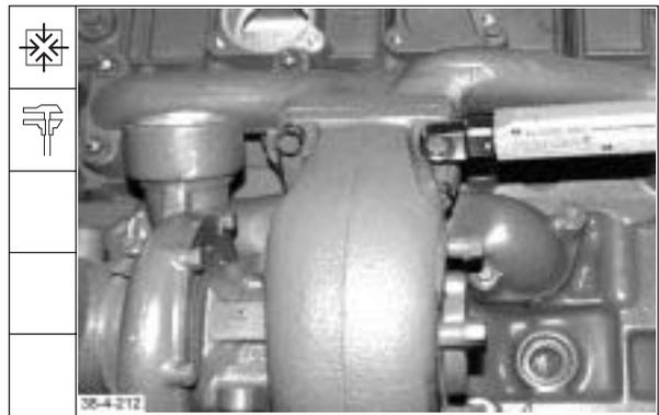
**Ölrücklaufrohr/Druckölleitung BFM 1012**
