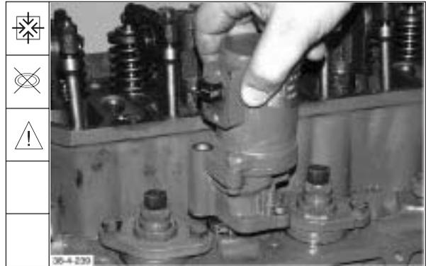
113. Schrauben mit einem Drehmoment von  $21$  Nm festdrehen.
