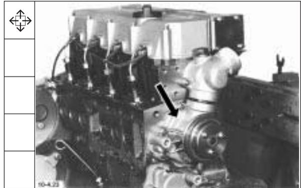
23. Falls vorhanden, Glühkerzen-Kabelkupplung trennen. Hierzu Hilfswerkzeug vorsichtig ohne Drehbewegung in die Gummitülle einführen und Kabel trennen.
