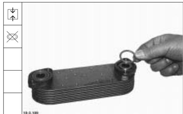
4. Ölkühler in Ölkühlergehäuse montieren. Befestigungsschrauben mit neuen CU-Ringen und einem Drehmoment von **20 Nm** festdrehen.
