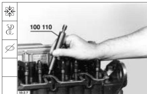
2. Spannpratze aufsetzen. Schraube festdrehen.
