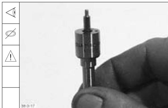
**Hinweis:** Bei ruckweisem Abgleiten der Düsennadel die Einspritzdüse erneut in Dieselmotorenöl auswaschen, bei Bedarf erneuern. Neue Einspritzdüse ebenfalls in sauberem Dieselmotorenöl reinigen.
