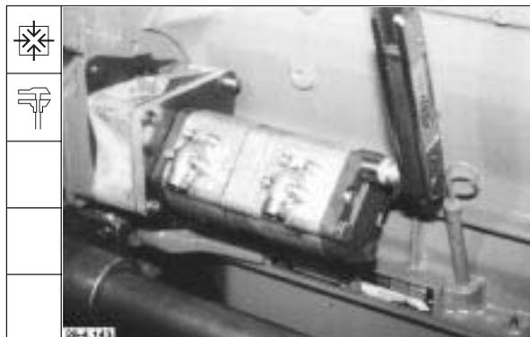
10. Öldruckleitung mit neuen Cu-Dichtungen anbauen.
