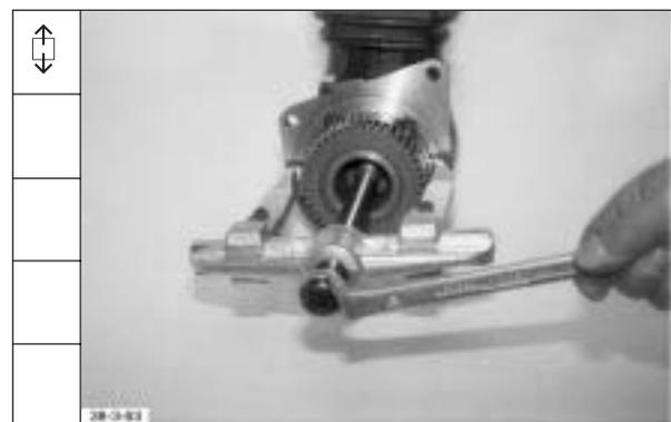
3. Zahnrad aufsetzen und Befestigungsmutter beidrehen.
