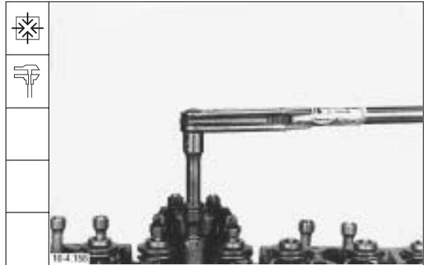
104. Zylinderkopfschrauben nach Anziehvorschrift festdrehen.
