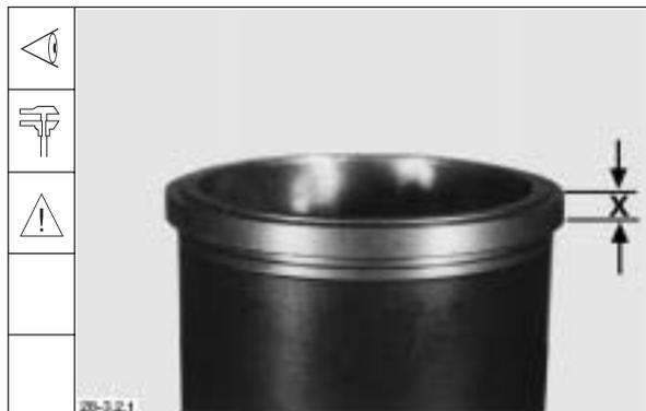
5. Bundauflage und Dichtfläche für Zylinderlaufbuchse sichtprüfen.
