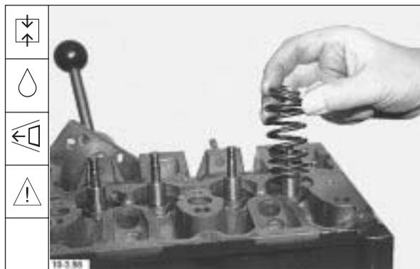
16. Ventilfedermontagehebel aufbauen,
