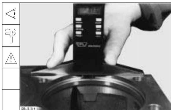
**Entsprechen die Messungen der Zylinder den angegebenen Werten, ist nach Bedarf das Zylinderkurbelgehäuse instandzusetzen.**
