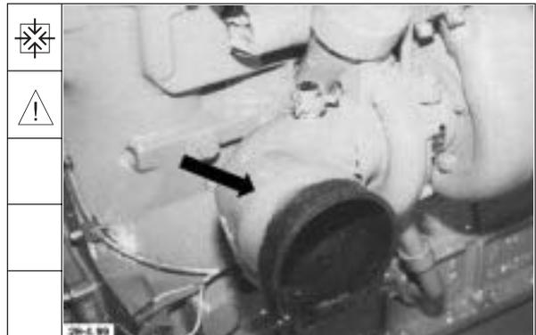
198. Entlüftungsleitung mit Halter spannungsfrei anbauen.
