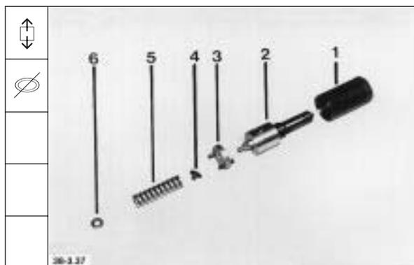
Sämtliche Teile in sauberem Dieselmotorenöl reinigen und mit Druckluft ausblasen.
