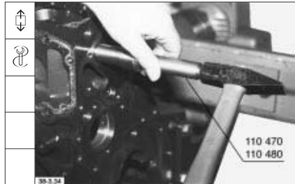
22. Führungsbuchse schwungradseitig austreiben, bei BF6M Motor.
