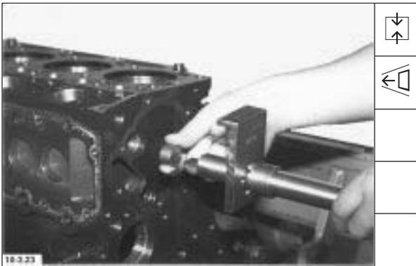
24. Führungsbuchse auf den Montagedorn, mit der Anfasung zum Kurbelgehäuse weisend, aufsetzen.
