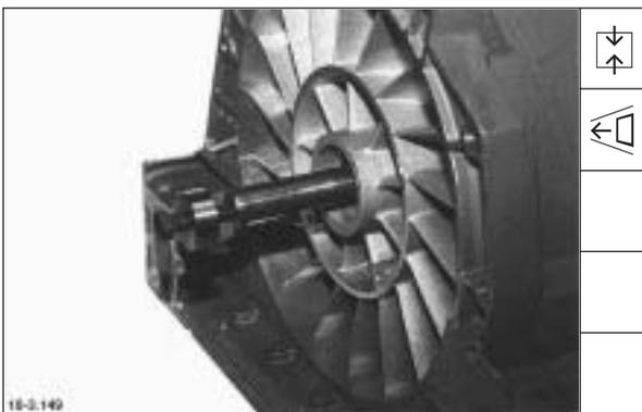
14. Hohlwelle mit Schraube und Scheibe durch Distanzbuchse führen.
