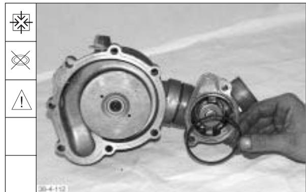
136. Vormontierte Kühlmittelpumpe mit neuer Dichtung anbauen.
