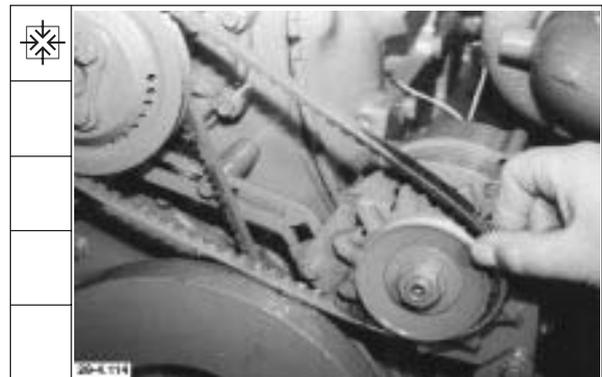
215. Keilriemen spannen. Schrauben mit einem Drehmoment von **30 Nm** festdrehen.
