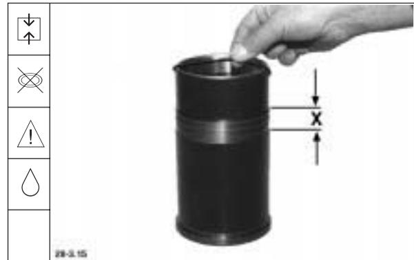
36. Zylinderlaufbuchse bis Anlage eindrücken.
