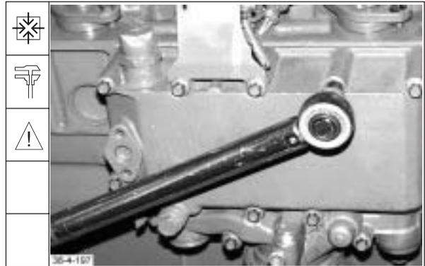
129. Beide Einschraubstutzen mit neuer Cu-Dichtung anbauen.
