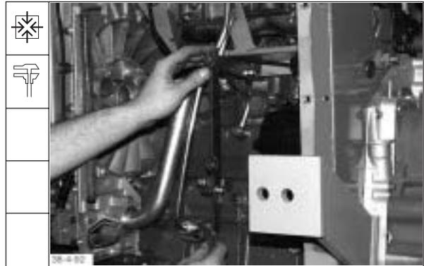
70. Flüssigkeitskühler anbauen. Schrauben mit einem Drehmoment von **9 ± 1 Nm** festdrehen.
