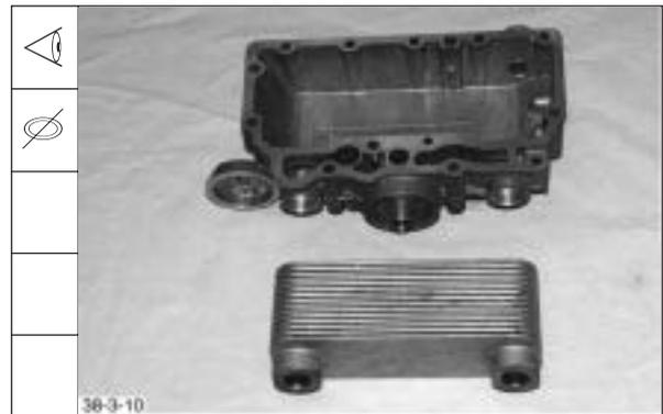
4. Ölkühler in Ölkühlergehäuse einsetzen.
