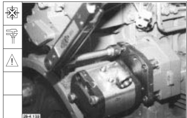
4. Dichtung in Einbaulage schieben. Schrau-ben von Hydraulikpumpe mit einem Dreh-moment von  $50 \pm 10 \text{ Nm}$  festdrehen.
