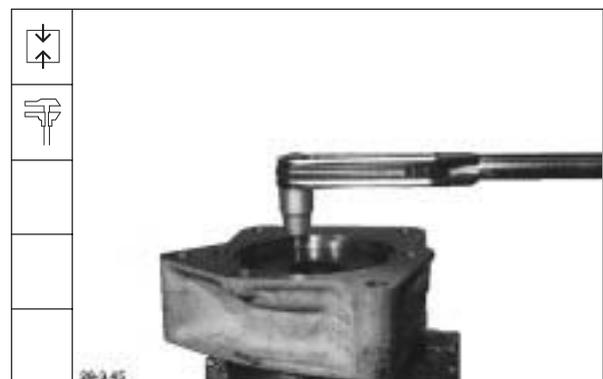
10. Neuen Runddichtring montieren.
