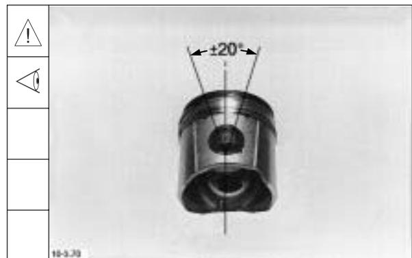
16. Kolben mit der Pleuelstange montieren.
