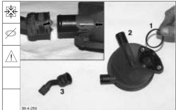
174. Gummimuffe bis zum Anschlag in die Räderkastenbohrung eindrücken. Druckregelventil an Zylinderkopf anbauen.
