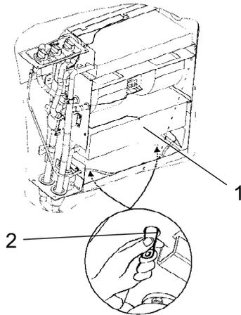
Limpe el polvo de la unidad de refrigeración (1) con aire comprimido.
