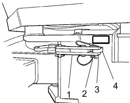
**Fig. Articulación en posición abierta**
