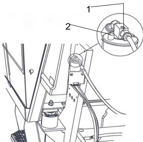
**Fig. Filtro de secado del compartimento del motor**
