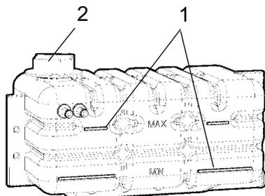
**Fig. Depósito de refrigerante**
