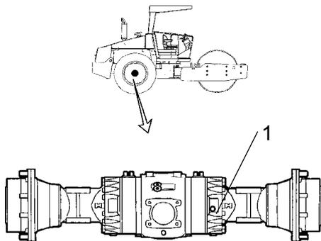
Limpie y retire el tapón de nivel (1) y compruebe que el nivel del aceite llega al extremo inferior del agujero del tapón. Llene con aceite hasta el nivel adecuado si éste es bajo. Utilice el aceite de transmisión, consulte la especificación de lubricación.
