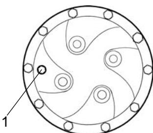
**Fig. Comprobación del nivel - planetario, opcional**
