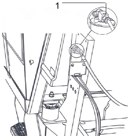
**Fig. Filtro de secado**
