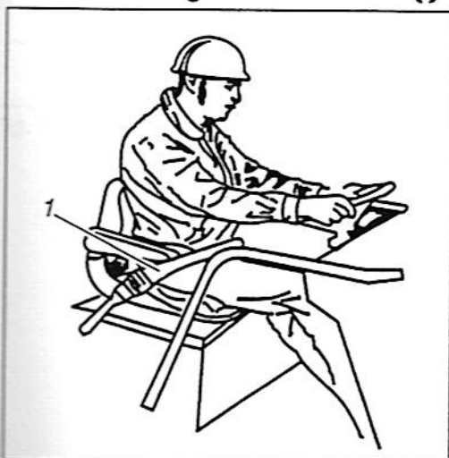
Fig. 11 - Asiento del operador 1. Cinturón de seguridad
