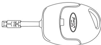
Coloque un destornillador de punta plana cuidadosamente en la ranura de la llave y separe las dos mitades del comando a distancia.
