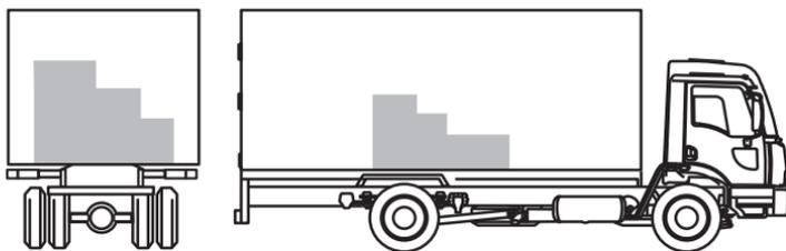
La distribución correcta de la carga sobre los ejes está establecida cuando el centro de gravedad de la carga se ubica un poco por delante del eje trasero.
