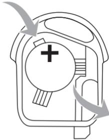
Con cuidado y con la ayuda de un destornillador, presione el pestillo y retire la batería. No toque los contactos de la pila ni la tarjeta de circuito impreso con el destornillador. Coloque la nueva batería. El contacto de la batería positivo (+) debe ir orientado hacia arriba.
