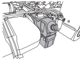
La solución de urea es inyectada en el sistema de escape por la unidad dosificadora del sistema de post-tratamiento. La cantidad de fluido inyectado es controlada por el Módulo de Control Electrónico del Motor. En cuanto al material particulado (MP), es reducido en el propio motor durante la combustión.
