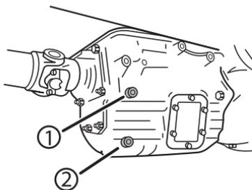
Reabastecer la caja con el lubricante recomendado en la Tabla de Lubricantes y Operaciones de Lubricación, hasta el borde inferior del agujero del tapón de nivel y carga.
