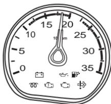
**Franja 3 – Advertencia:** Indica que el motor está entrando en rotación excesiva. Cuando el motor se aproxime a la franja roja, entrará en acción el sistema de protección del motor, moderando la alimentación de combustible y la velocidad de rotación. En algunas situaciones de reducción de velocidad, la aguja puede entrar en la franja de advertencia, no causando daños al motor.
