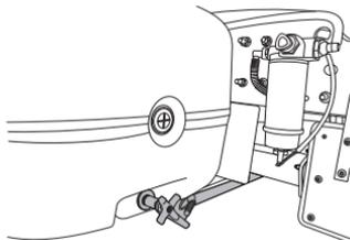
En los modelos equipados con dos tanques de combustible, la comunicación se realiza mediante un registrador, que abre o cierra, para permitir el pasaje de combustible.
