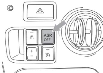
Para desactivar el control automático de tracción, accione el interruptor. La luz indicadora del panel ASR enciende indicando que el sistema fue desactivado.
