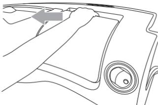
Para remover la tapa de la central eléctrica, tire de su parte superior.
