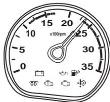
**Franja 4 – Roja:** Indica rotación excesiva. En desaceleraciones y al transitar en declives, accione una marcha compatible y use el freno motor y/o el freno de servicio para controlar la velocidad de rotación del motor.
