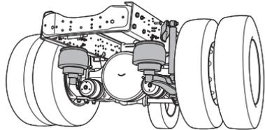
La suspensión neumática garantiza el nivel del chasis durante la operación del vehículo y facilita el procedimiento de acople y desacople el semirremolque.
