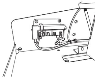
Para abrir la tapa, presione las trabas y levante hacia el lado derecho.
