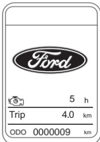
Resumen: Aparece cuando se abre la puerta, se apaga el motor o el botón es presionado. La pantalla resume la información del vehículo; horímetro total, odómetros total y parcial.
