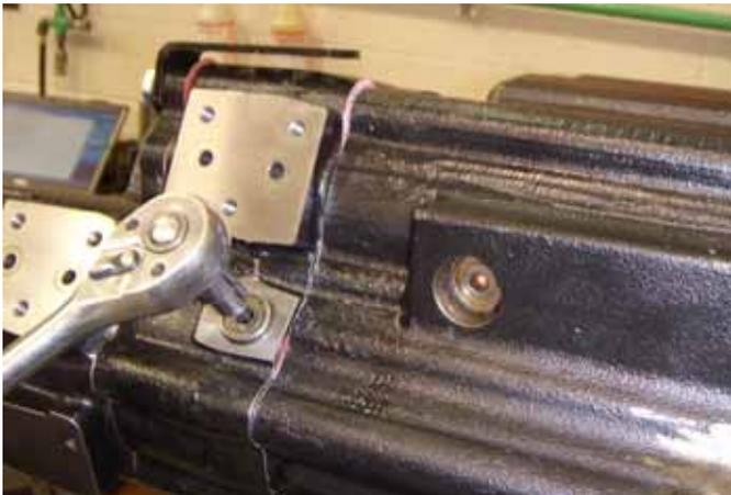
1. Suelte los conectores de los mazos de los interruptores de la Reducción y Súper Reducción. Remueva el(los) interruptor(es) de la Reducción y/o Súper Reducción y la(s) junta(s) de la(s) tapa(s) del(de los) cilindro(s) de reducción.
