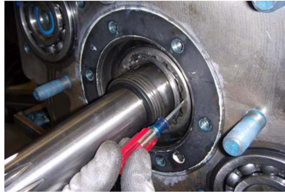
2. Instale el espaciador del Eje Primario.
