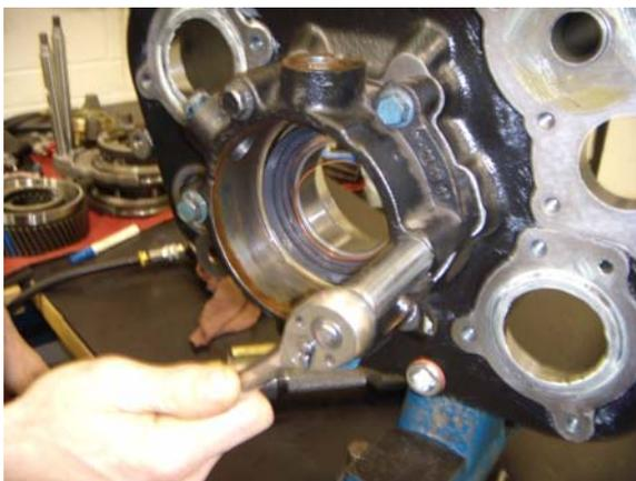
10. Remueva los seis tornillos sextavados de la tapa del rodamiento trasero, remueva la tapa y, enseguida, remueva el sello del rodamiento trasero. Vaya a sección "Cómo Remover el Sello de Aceite del Eje Principal Auxiliar".
