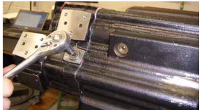
12. Utilizando lubricante Nyogel, Pieza N° 5564527, reinstale el mazo de la transmisión en los dos interruptores de la reducción.
