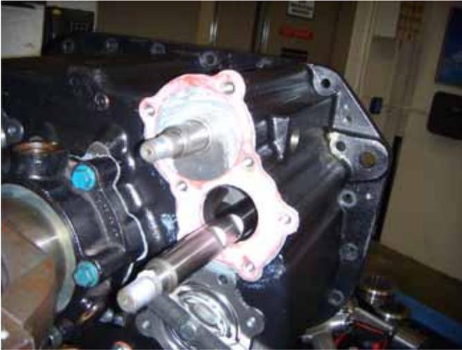
3. Instale la junta en la parte trasera de la carcasa de la sección auxiliar para la carcasa del cilindro de la reducción e instale la carcasa del cilindro de la reducción en la sección auxiliar.
