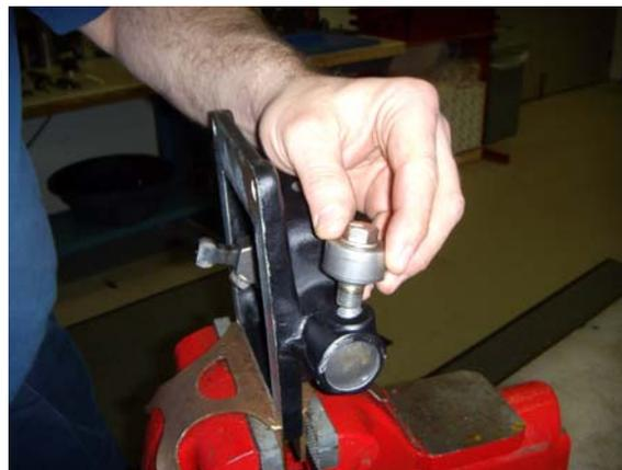
7. Instale la funda de cambio y la abrazadera de sellado. Posicione la funda y la abrazadera y apriete la abrazadera.
