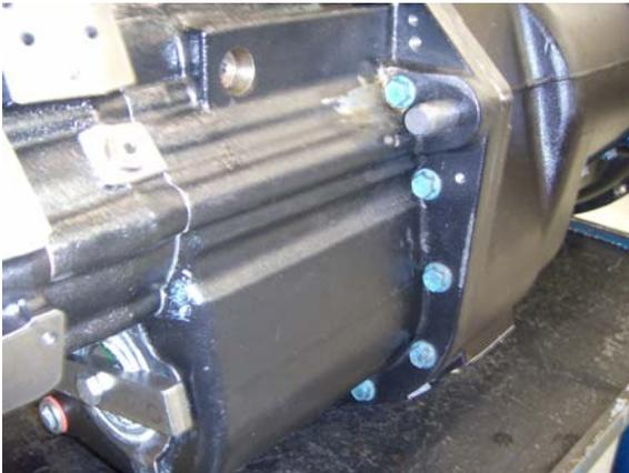
**Nota:** Los agujeros con roscados de los tornillos sextavados están asentado en el área de los pernos guía de la carcasa de la sección auxiliar para ayudar en el apartamiento de la junta. Inserte 2 tornillos sextavados de retención de la carcasa auxiliar en los agujeros con roscados y apriételes igualmente hasta que la junta se aparte.
