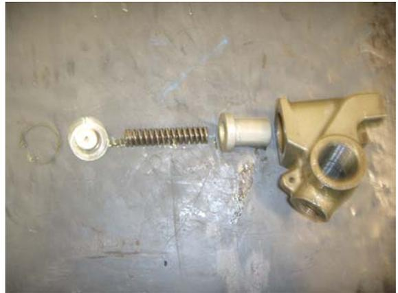
4. Inserte el bloque de cambio en la carcasa de las barras de cambio y lentamente deslice la barra para el bloque de cambio y para el soporte de la barra de cambio central.
