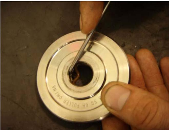
9. Cuando fuera necesario, remueva los bujes de la barra de la horquilla de las carcasas del cilindro de la reducción / súper reducción con un punzón y un mazo blandos, en caso de que estén desgastados.
