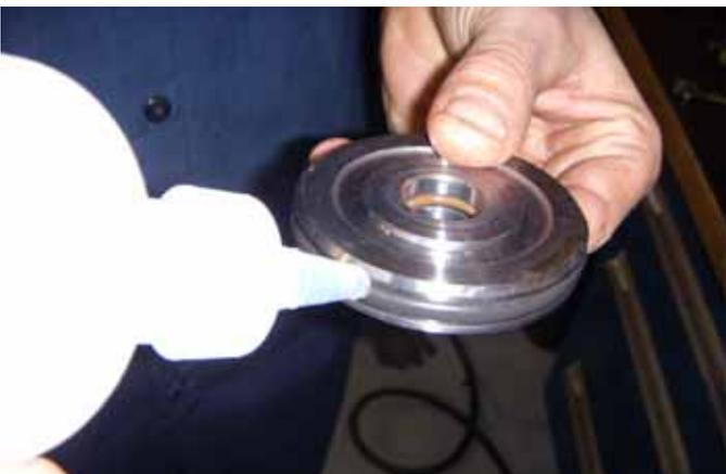
8. Instale los anillos "O" interno y externo en el pistón de la súper reducción y aplique lubricante de Silicona Eaton Fuller, Pieza N° 71206, o producto equivalente, en el alojamiento del pistón y en los anillos "O".
