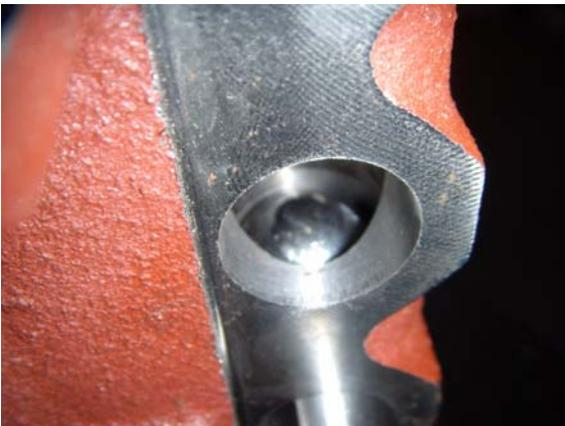
8. Inserte la esfera de bloqueo en el alojamiento de la carcasa de las barras de cambio y compruebe que esté apoyado contra la barra de cambio de la 3a/4a, con la barra en la posición de marcha neutra.
