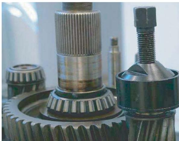
5. Cuando fuera necesario, remueva los conos de los rodamientos del contraeje auxiliar de la carcasa principal de la transmisión, utilizando el extractor de rodamiento de rodillos del contraeje, pieza E12007.
