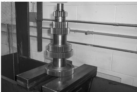
7. Alinee la ranura de la chaveta de la 4<sup>a</sup> marcha con la chaveta del contraeje y presione el engranaje y el manguito en el contraeje.
