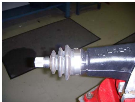
8. Alinee las marcas de orientación e instale el brazo de cambio en la barra de cambio. Aplique adhesivo Eaton/Fuller n° 71205 o producto equivalente en el perno de retención y apriételo con 48-61 N.m (35-45 lbs.pies).
