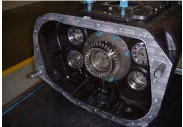
5. Alinee la sección auxiliar en la posición correcta y alinee con los pernos guía. Deslice la sección auxiliar en los pernos guía y remueva el adaptador de la transmisión.
