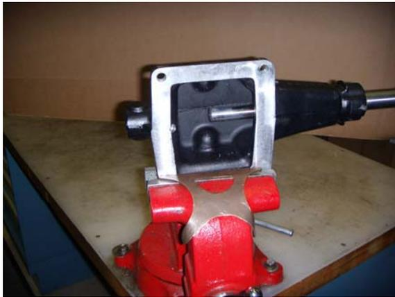
4. Instale la barra de cambio en la carcasa, el resalto de cambio y el resorte en la barra de cambio, para que la barra de cambio deslice hasta la posición correcta. Deslice el resalto de cambio para los estriados de la barra de cambio.
