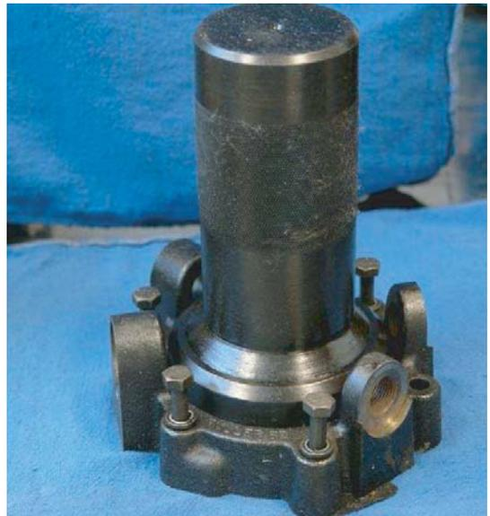
7. Instale una junta en la tapa del rodamiento trasero y la tapa con los seis tornillos sextavados de retención, apretándolos con 54-61 N.m (40-45 lbs.pies).
