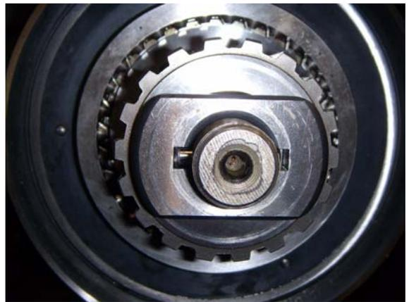
14. Cuando fuera necesario, instale los bujes en el agujero de la horquilla de la reducción de la carcasa auxiliar.
