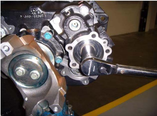
3. Remueva la tuerca de retención del pistón de la súper reducción, utilizando sólo herramientas manuales.
