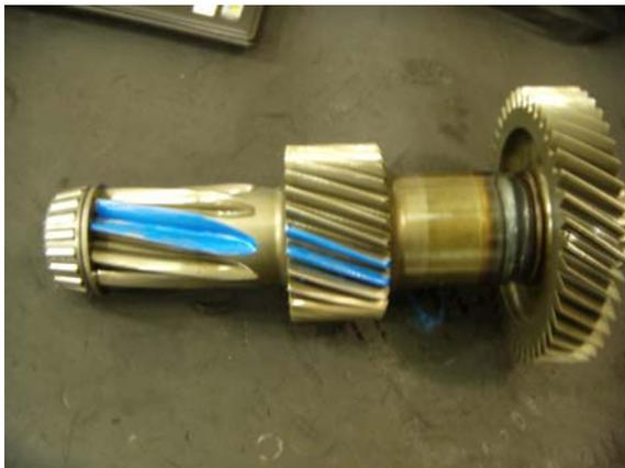
2. Cuando fuera necesario, instale las arandelas y los rodamientos en ambos contraejes y señale los engranajes de los contraejes en las marcas de sincronismo determinadas, utilizando una tinta. Vaya a sección "Sincronismo" del manual para más informaciones.
