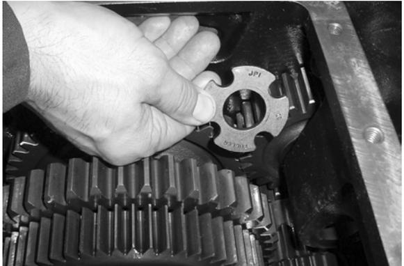
3. Inspeccione el anillo elástico trasero y la placa por daños o desgaste, y reemplace cuando fuera necesario.
