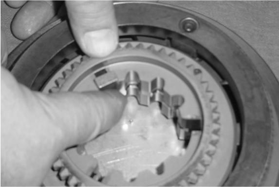
9. Instale los resaltos del sincronizador.
