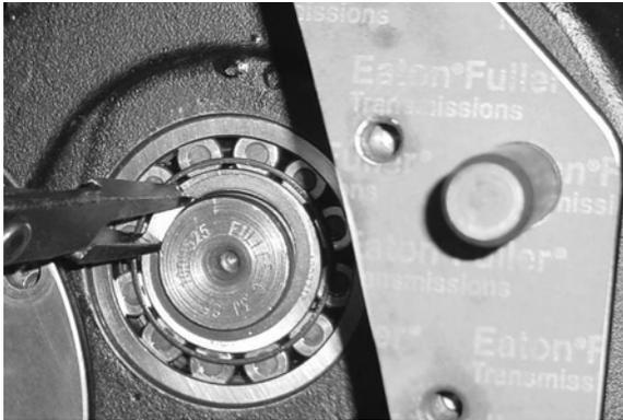
6. Instale el anillo elástico dentro de la parte trasera del contraeje.
