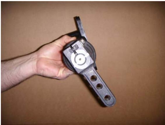
6. Apunte la dirección del brazo de cambios para el eje de cambios con una tinta para señalización de herramientas y, enseguida, suelte el perno de retención del brazo de cambio y remuévalo.
