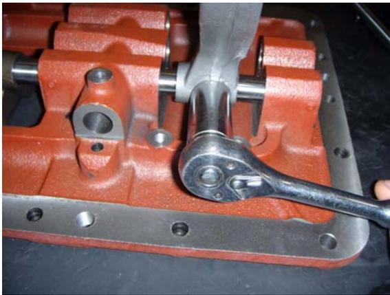
19. Apriete todos los tornillos sextavados de retención de las horquillas de cambio con 54-61 N.m (40-45 lbs. pies), instale los alambres de seguridad en todos los tornillos sextavados de las horquillas/barras de cambio y fije los alambres con seguridad.
