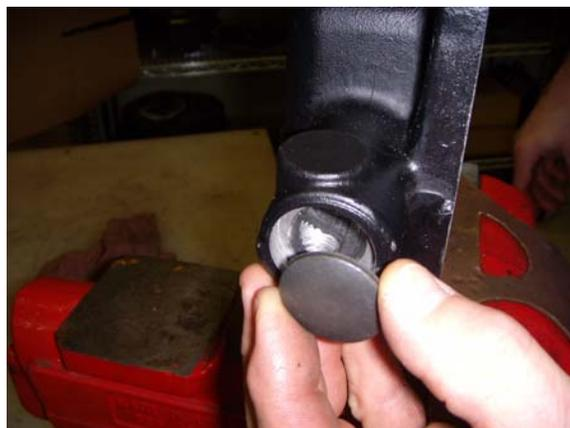
15. Cuando fuera necesario, remueva los bujes de la barra de cambios de la carcasa del control remoto de cambios, utilizando un instalador de bujes y un mazo blando.
