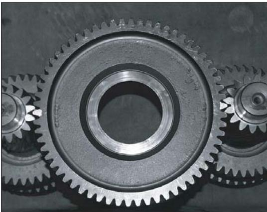
Ejemplo presentando el visón correcto del Engranaje de la Reducción sincronizada con los engranajes de los Contraejes en la bancada.
