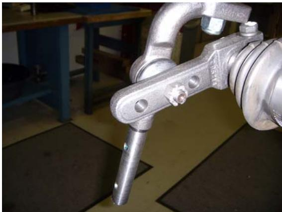
11. Instale la tuerca castillo de la articulación de retención del prisionero del pivote de la articulación y apriételo con 41 N.m (30 lbs.pies), por lo menos, alineada con el próximo agujero de la chaveta de retención. No desapriete la tuerca para obtener el alineamiento con el agujero de la chaveta. Compruebe que el prisionero del pivote de la articulación se alinee con el rebaje de la tuerca castillo de la articulación.
