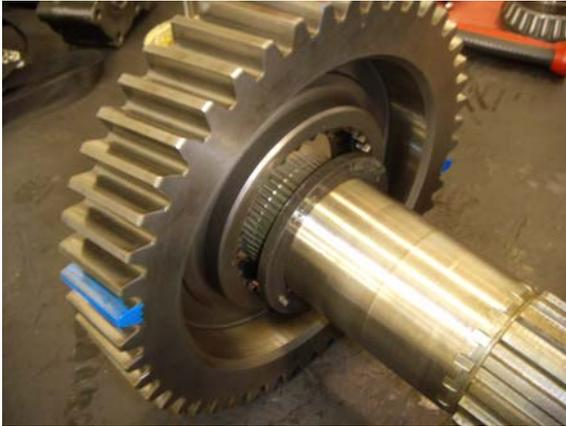
3. Instale la arandela llana en el engranaje del eje principal auxiliar, engranaje de la súper reducción y arandela con rebajo en el eje principal auxiliar.
