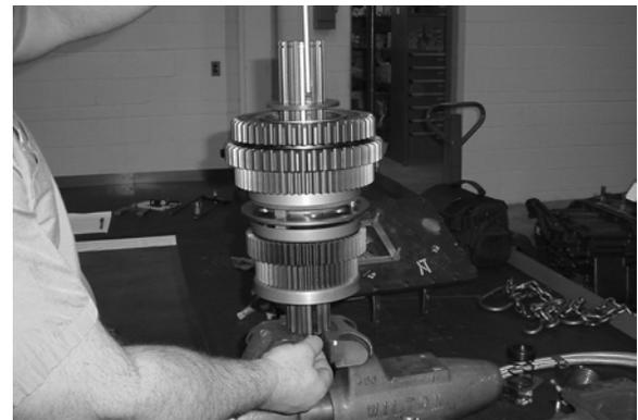
17. Instale el sincronizador del eje principal delantero.
