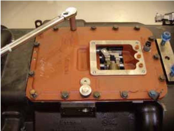
3. Instale todos los 16 tornillos sextavados de la carcasa de las barras de cambio y apriételos con 54-61 N.m [40-45 lbs.pies].
