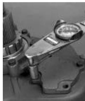
**Nota:** Utilice una grasa espesa para mantener los calzos en la posición correcta al instalar la tapa.
