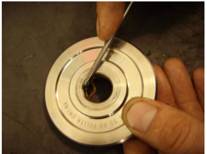
10. Cuando fuera necesario, remueva los bujes de la carcasa de los cilindros de la reducción/súper reducción, en caso de que estén desgastados.
