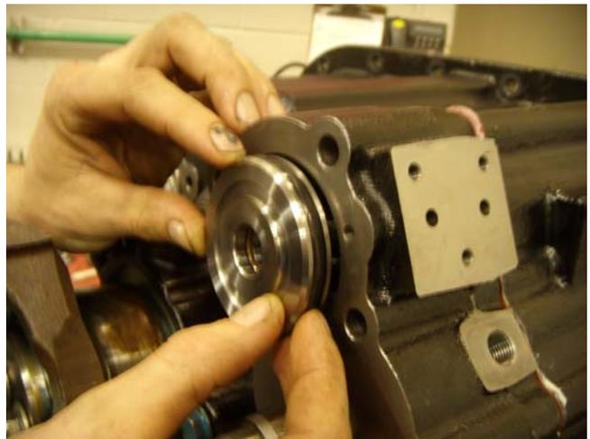
5. Instale la tuerca del pistón de la reducción y apriételo con 95-115 N.m [70-85 lbs. pies] de torque.
