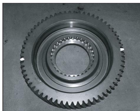
3. Localice las dos señales "O" grabadas en los engranajes de la Reducción de los Contraejes y señale con una tinta muy visible, de preferencia amarilla o blanca.
