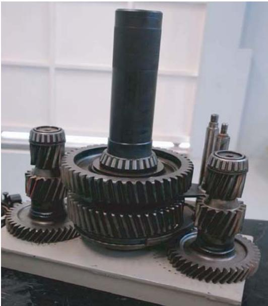
4. Calienta el rodamiento del eje principal auxiliar o utilice la prensa y un adaptador de rodamiento con dimensiones apropiadas para instalar el rodamiento en el eje principal auxiliar, hasta que esté totalmente asentado en la arandela con rebajo.
