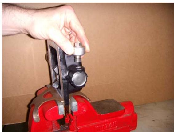
9. Apunte la dirección del resalte de cambio hasta el eje de cambios
