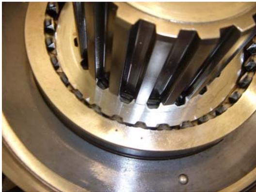
11. Instale el engranaje de reducción del eje principal de la reducción en el cubo del engranaje de la reducción. Enseguida, instale la arandela con hendidura en el eje y póngalo en el engranaje. Enseguida, gire la arandela hasta que los estriados del eje principal de la reducción estén alineados. Gire suavemente el conjunto y, con un mazo y una barra blanda, inserte las espigas de fijación de la arandela hasta que se queden asentadas bajo la superficie inferior del engranaje.
