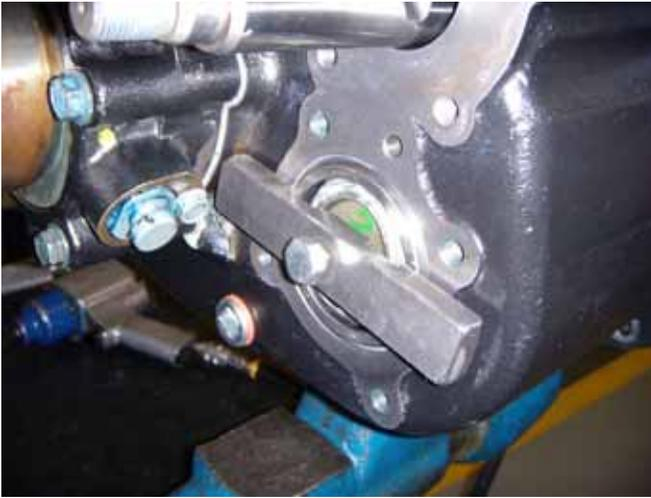
8. Remueva las cintas de retención de los rodamientos del contraeje y compruebe que los rodamientos cónicos estén asentados en el lugar. Inicie los procedimientos de calzo de los rodamientos del contraeje.
