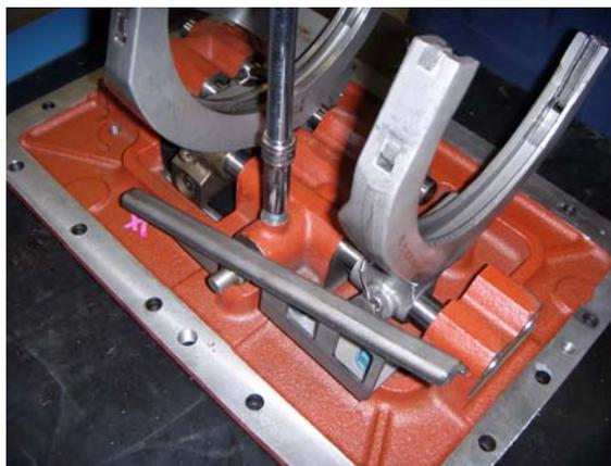
21. Instale el pasaje del aceite y los tornillos sextavados. Aplique adhesivo líquido para roscado Eaton Fuller n° 71205 y apriete los tornillos sextavados con 27-31 N.m [20-23 lbs.pies].
