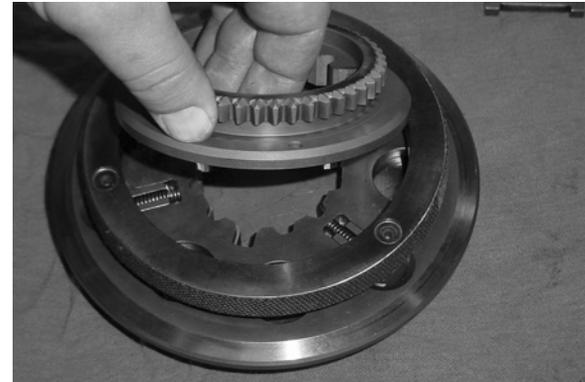
8. Compruebe que la ranura de la chaveta en la placa del sincronizador superior y el anillo de sincronización estén alineados.
