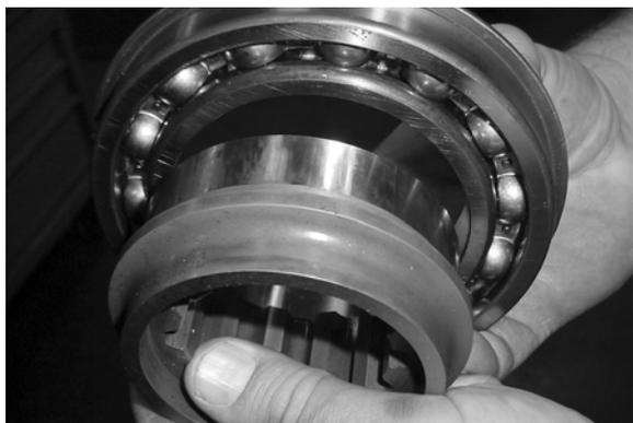
4. Mueva el rodamiento auxiliar y el manguito.
