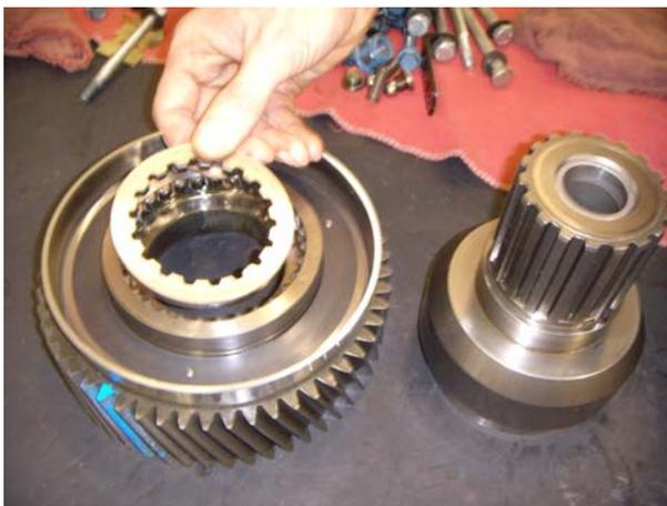
4. Gire la arandela de retención del engranaje del eje principal de la reducción, hasta que la arandela pueda ser removida del eje y, enseguida, remueva el engranaje de reducción. Cuando fuera necesario, remueva los bujes del cubo del engranaje de reducción con una barra blanda y un mazo de cada extremidad del cubo del engranaje de reducción.
