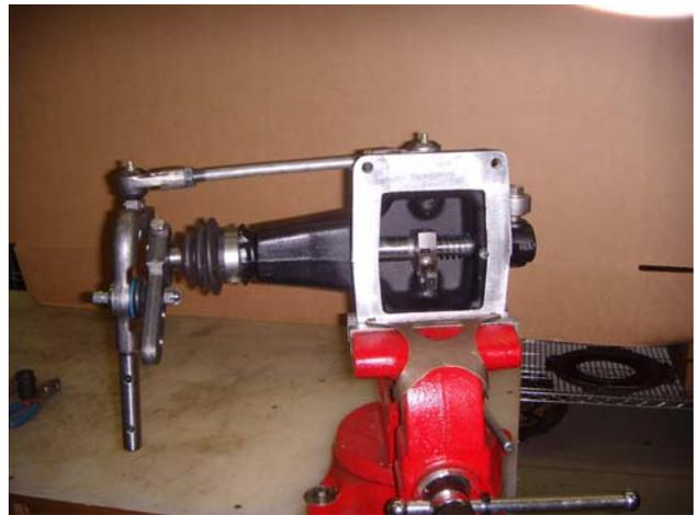
3. Remueva la claveta de retención de la tuerca castillo de retención del perno prisionero del pivote de la articulación y, enseguida, remueva la tuerca castillo de la articulación.
