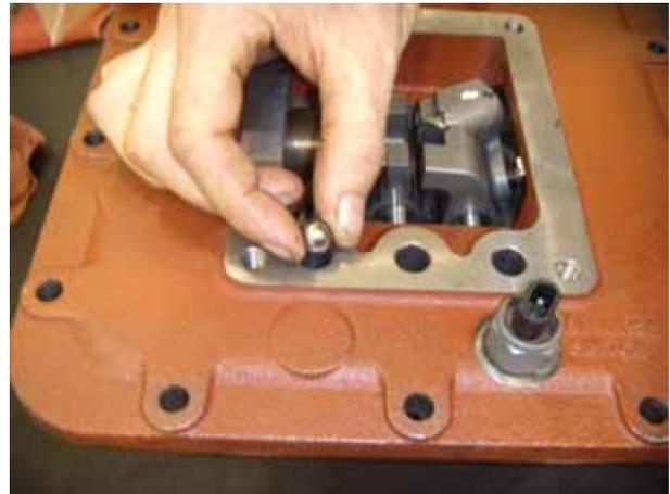
5. Reinstale el control remoto de cambios. Vaya a sección "Cómo Instalar el Control Remoto de Cambios" en el manual de servicios.
