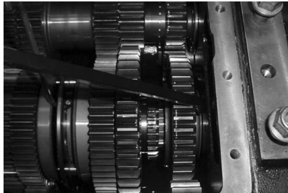
6. En el interior de la caja, utilice cuidadosamente el pie de cabra o golpee el rodamiento atrás hasta que el anillo elástico se quede expuesto.
