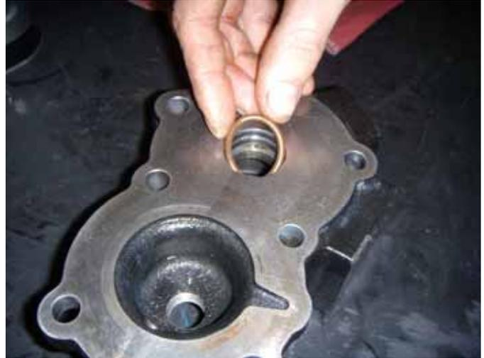
7. Instale la carcasa de la súper reducción y apriete los tornillos sextavados manualmente.
