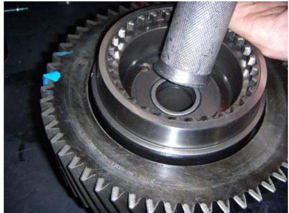
13. Instale el conjunto del engranaje de reducción del eje principal de la reducción en el eje principal auxiliar, con el eje de la reducción vuelto hacia adelante. Instale el perno guía del eje principal de la reducción, la arandela y la tuerca sextavada en el eje principal auxiliar con junta líquida Eaton/Fuller n° 71205 y apriete la tuerca con 244-288 N.m (180-210 lbs.pies).
