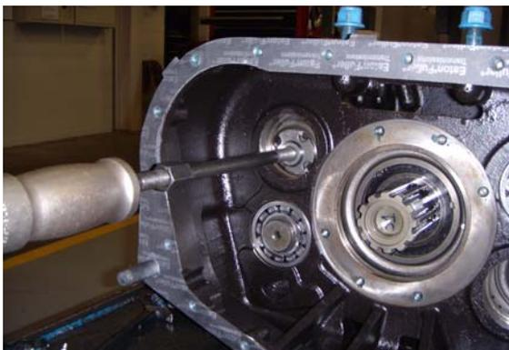
3. Instale el martillo deslizante en la parte trasera del eje intermedio de marcha atrás y remuévalo de la carcasa.
