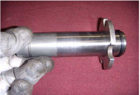
4. Instale el eje intermedio de marcha atrás con las manos hasta que él se encaje parcialmente en el agujero de la carcasa y agarre el engranaje y la arandela intermedia de marcha atrás.
