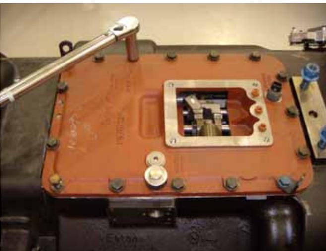
4. Remueva los 16 tornillos sextavados de retención de la carcasa de las barras de cambio y los soportes de sustentación.
