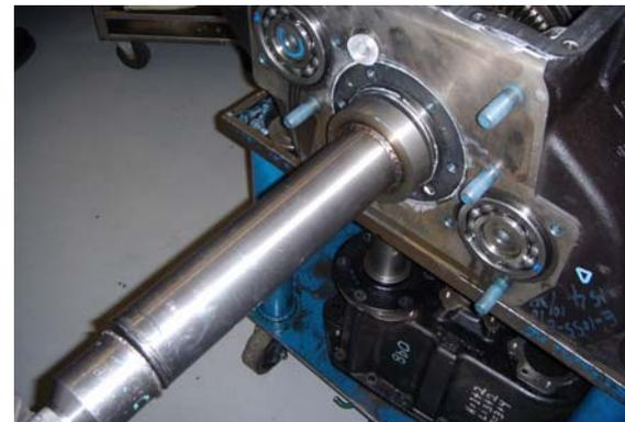
4. Instale el anillo elástico en la parte delantera del rodamiento primario.
