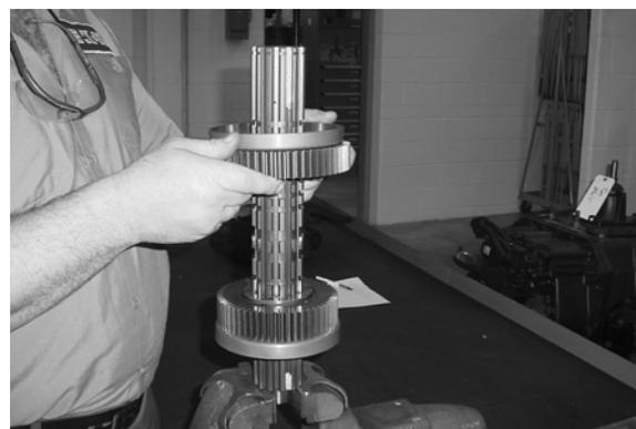
4. Instale la arandela llana. Gire la arandela hasta que los estriados de la arandela y los estriados del eje principal estén alineados.
