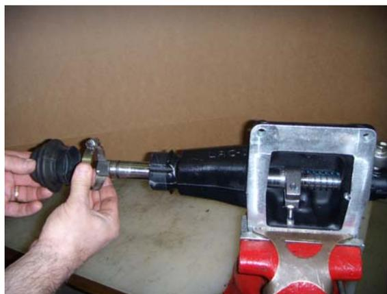
8. Cuando fuera necesario, suelte y remueva el respiradero de la transmisión de la carcasa del control remoto de cambio.
