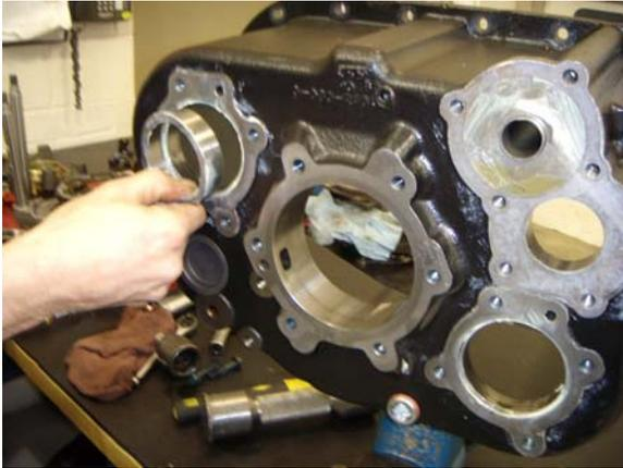
6. Cuando fuera necesario, remueva las pistas exteriores de los rodamientos del contraeje auxiliar de la carcasa auxiliar, utilizando una barra blanda y un mazo.
