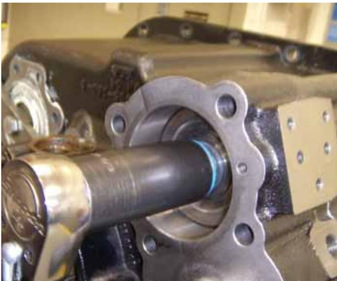
5. Remueva la tuerca de retención del pistón del cilindro de la reducción y remueva la carcasa del cilindro. Cuando fuera necesario, golpee levemente en la barra de la horquilla de la reducción con un martillo blando para removerla del pistón.
