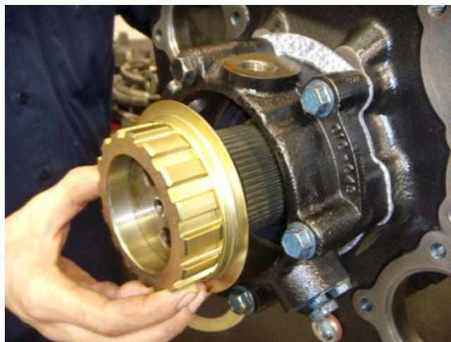
3. Remueva los seis tornillos sextavados de la Tapa del Rodamiento de Salida y, enseguida, remueva la Tapa del Rodamiento Trasero con la junta.
