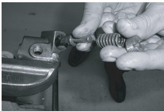
17. Instale la horquilla de cambio de la Reducida/Marcha atrás y deslice la barra de cambio para la horquilla de cambio de la Reducida/Marcha atrás.
