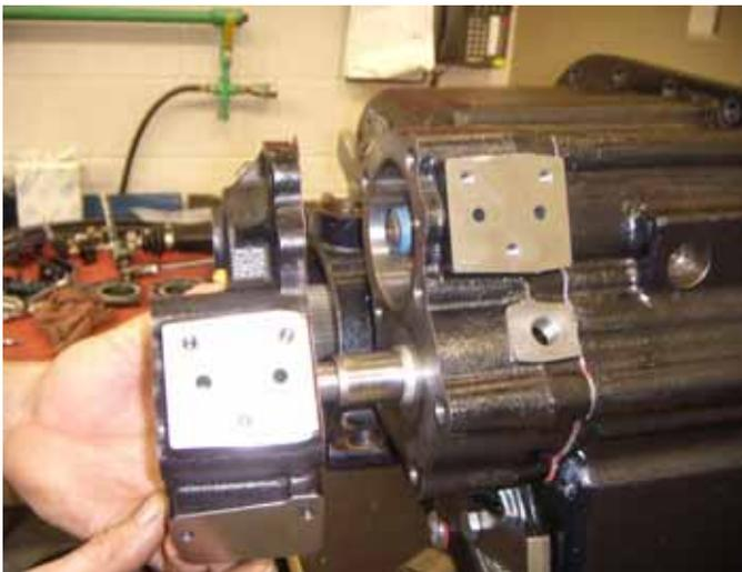
4. Remueva el último tornillo sextavado del cilindro de la súper reducción y enseguida remueva la carcasa del cilindro. Cuando fuera necesario, golpee levemente en la barra de la horquilla de la súper reducción con un martillo blando para removerla del pistón.
