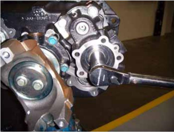
9. Inserte el pistón de la súper reducción en la barra de la horquilla de cambio de la súper reducción y apriete la tuerca sextavada con 95 - 115 N.m [70 - 85 lbs. pies].
