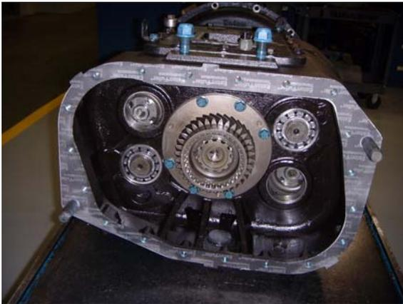
4. Aplique la junta líquida en la carcasa principal de la transmisión.
