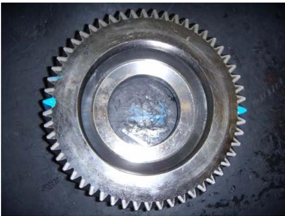
10. Utilizando tinta para señalar herramientas, señale dos dientes del engranaje de la reducción, apartados 180° entre sí. Vaya a sección "Sincronismo" del manual para más informaciones.
