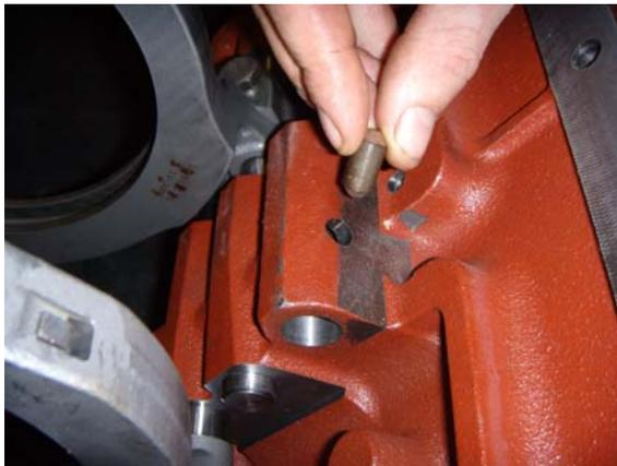
13. Instale el perno de bloqueo de la barra de cambio en el soporte de la barra de cambio (central) de la carcasa de las barras de cambio, comprobándose que esté apoyado contra la barra de cambio de la 1a/2a.
