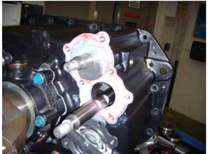
4. Aplique, Lubricante de Silicona Eaton Fuller, código de pieza 71206 o producto equivalente en el alojamiento del pistón y en los anillos "O". Aplique nuevos anillos "O" interno y externo del pistón de la reducción y, enseguida instale el pistón en el cilindro de la reducción.
