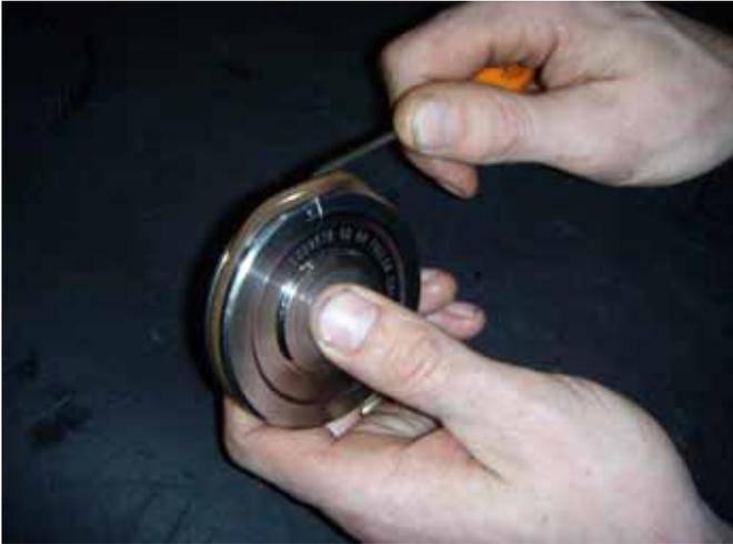
8. Remueva los anillos "O" interno y externo de los pistones de la reducción y de la súper reducción
