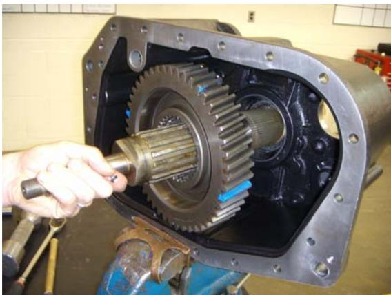
5. Inserte el conjunto del eje principal auxiliar en la carcasa auxiliar e instale el rodamiento trasero del eje principal auxiliar en el eje y golpee en el rodamiento con una barra blanda y un mazo para insertarlo a lo máximo.
