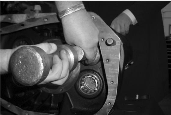
5. Instale el rodamiento y utilice el instalador para posicionar el rodamiento trasero en su posición.
