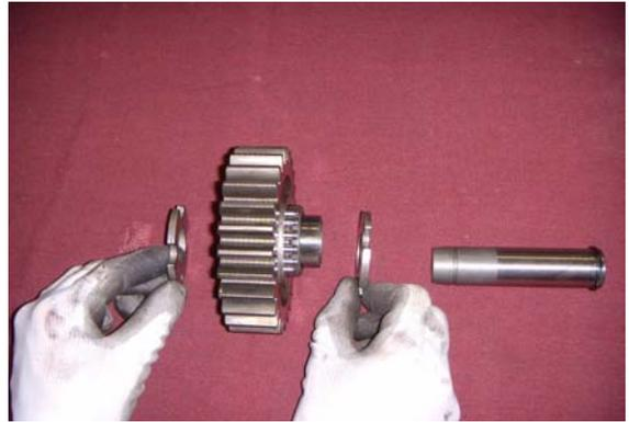
2. Inserte la arandela, como exhibido, con la grabación vuelta a la parte delantera de la transmisión.
