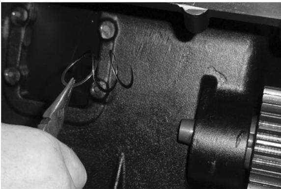
1. Remueva el anillo elástico de salida cónica del eje.
