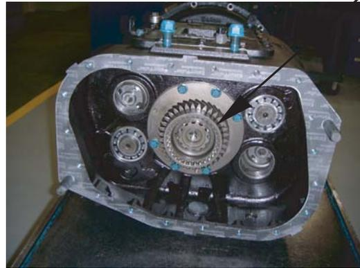
9. Instale los tornillos sextavados del anillo de retención del rodamiento auxiliar. Apriete con 54-61 N.m (40-45 lbs. pies).
