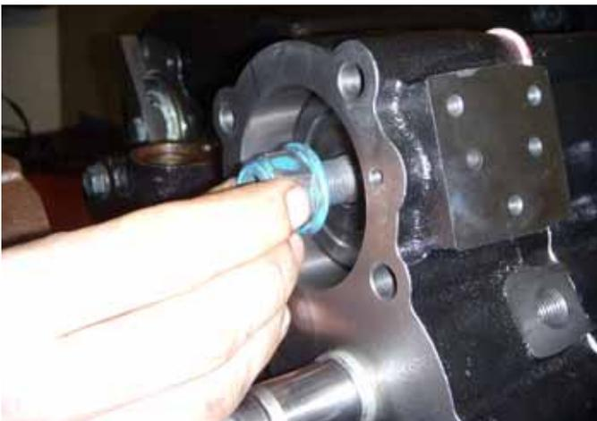
5. Instale la tuerca del pistón de la reducción y apriételo con 95-115 N.m [70-85 lbs. pies] de torque.
