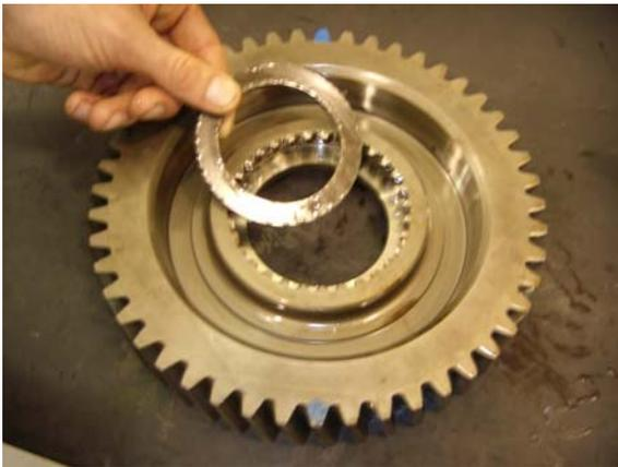
9. Remueva la arandela con rebajo del engranaje del eje principal auxiliar, el engranaje de reducción y la arandela llana del eje.
