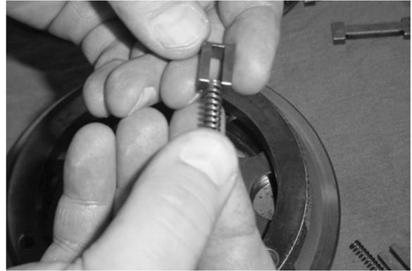
6. Instale las chavetas aplicando presión en la salida del resorte con un destornillador pequeño.
