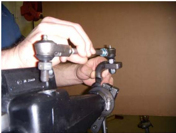
5. Suelte el prisionero de retención del vástago de control de la articulación en la carcasa del control remoto de cambios y, enseguida, suelte el prisionero y remueva el vástago de control de la articulación.
