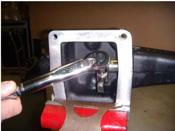
5. Aplique adhesivo Eaton/Fuller n° 71205 o producto equivalente en el perno de retención del resalto de cambio e instale el perno de retención, apretándolo con 48-61 N.m (35-45 lbs.pies).
