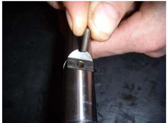
10. Inserte parcialmente la barra de la 1a/2a en el soporte de la barra de cambio central, comprobándose que la barra de cambio de la 3/4 esté en la posición neutra, para que la esfera de bloqueo de la barra de cambio esté asentada en la ranura de retención de la barra de cambio de la 3a/4a.
