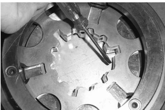
4. Compruebe que la ranura de la claveta en la placa del sincronizador y el anillo de sincronización estén alineados.
