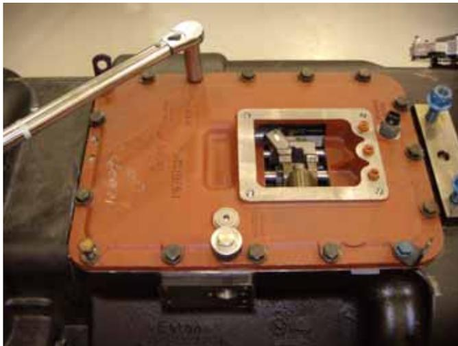
4. Remueva los 16 tornillos sextavados de retención de la carcasa de las barras de cambio y los soportes de sustentación.
