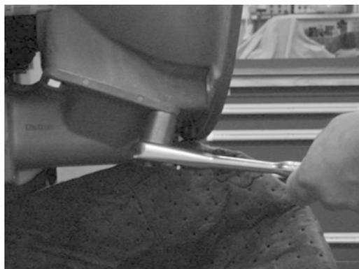
6. Baje la carcasa del actuador y remuévala de la carcasa del embrague.
