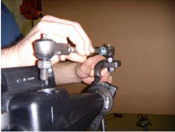
9. Aplique adhesivo Eaton/Fuller n° 71205 o producto equivalente en el prisionero de retención del vástago de control de la articulación e instale el vástago en la carcasa del Control Remoto de Cambio, apretando el prisionero con 61-74 N.m (45-55 lbs. pies)
