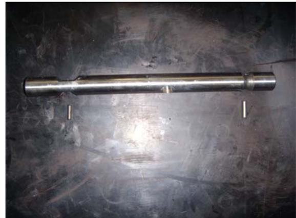
11. Remueva la esfera de bloqueo de la barra de cambio y el perno de bloqueo de la reducción de la carcasa de las barras de cambio.
