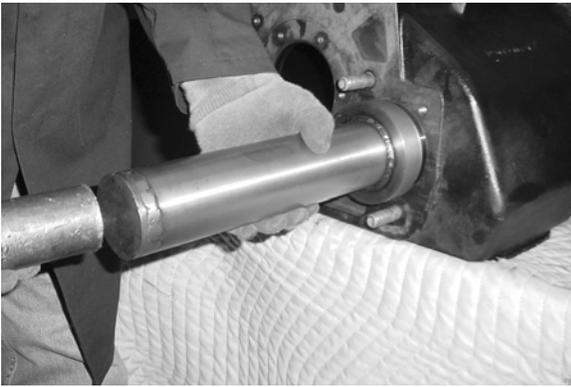
4. Instale el rodamiento del contraeje delantero y guíelo con el instalador de rodamiento.
