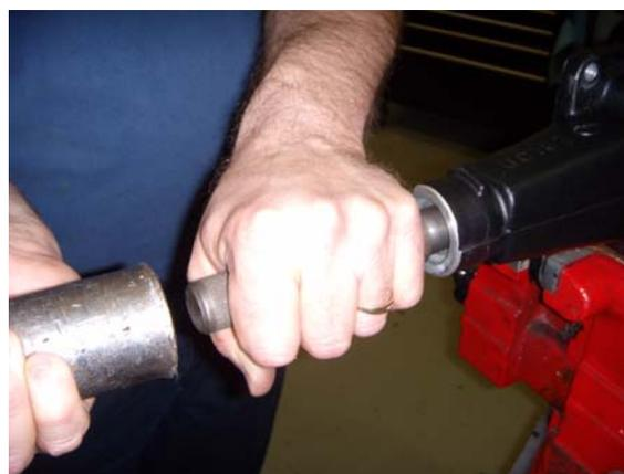
2. Reinstale el buje de expansión de la barra de cambios con una barra blanda y un mazo blando.
