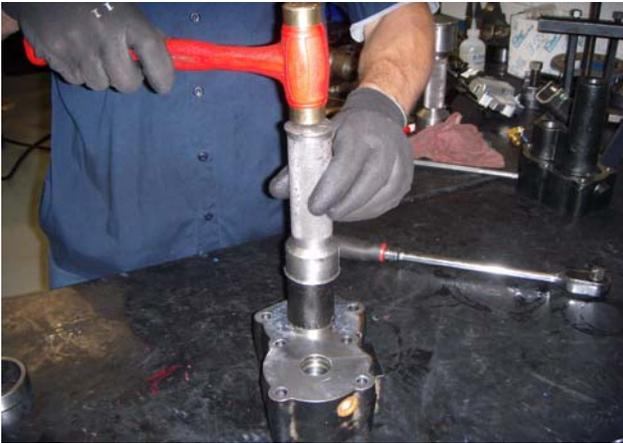
2. Instale el anillo "O" en la carcasa de la reducción, utilizando lubricante de Silicona Eaton Fuller Pieza N° 71206, o producto equivalente.
