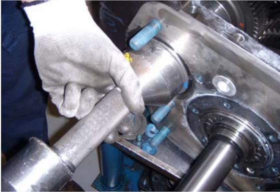
4. Utilice un instalador de rodamiento para instalar el rodamiento del contraeje delantero.
