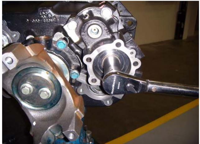
5. Remueva el último tornillo sextavado de la carcasa del cilindro de la súper reducción y enseguida remueva la carcasa del cilindro. Cuando fuera necesario, golpee levemente en la barra de la horquilla de la súper reducción con un martillo blando para removerla del pistón.
