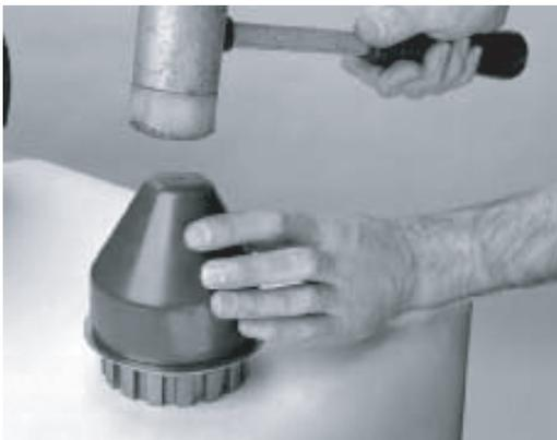
3. Si el anillo "O" hubiera sido previamente removido, instale en el eje de salida.
