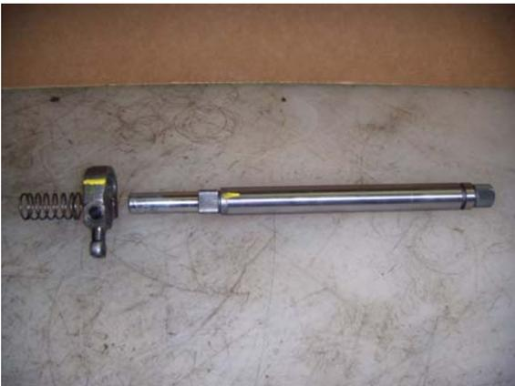
12. Remueva el resalto de cambio y el resorte de la carcasa del control remoto de cambio. control housing.
