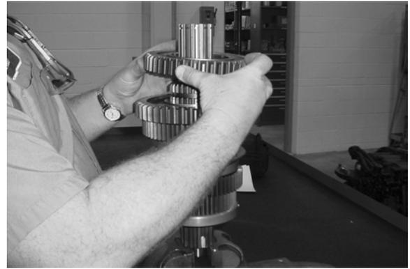
15. Instale la arandela llana. Gire la arandela hasta que los estriados de la arandela y los estriados del eje principal estén alineados.
