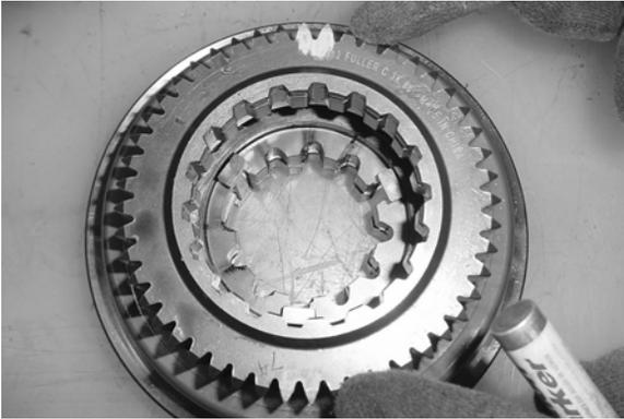
18. Señale dos dientes en el engranaje motriz principal y, enseguida, señale dos dientes directamente opuestos. Utilice una tinta visible para señalar las herramientas, con colores como amarillo o blanco.
