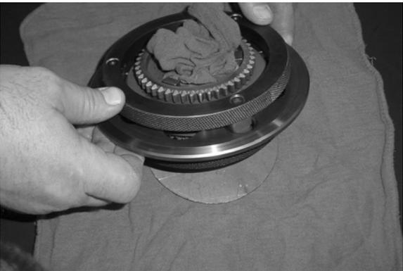
10. Ponga un trapo en el centro del sincronizador hasta que esté listo para ser instalado.
