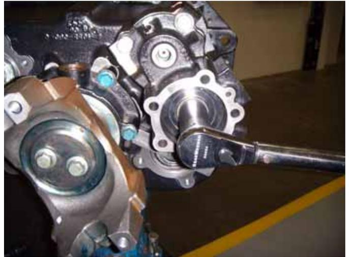
10. Instale la junta de la tapa del cilindro de la súper reducción, la tapa y los tornillos sextavados. Apriete los tornillos sextavados con 54-61 N.m [40-45 lbs. pies]
