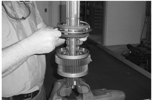
8. Instale la próxima arandela por el sincronizador. Gire la arandela hasta que los estriados de la arandela y los estriados del eje principal estén alineados.
