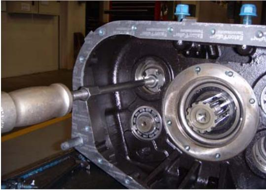
5. Instale el martillo deslizador (herramienta especial) en la parte trasera del eje intermedio de la marcha atrás y remueva el eje.
