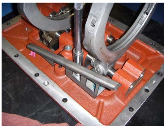
22. Cuando fuera necesario, instale el respiradero de aceite en la carcasa de las barras de cambio, cerca de la posición señalada "neutral switch" (interruptor de marcha neutra) y apriétele con 20,3-27,1 N.m [180-240 lbs.pul.].
