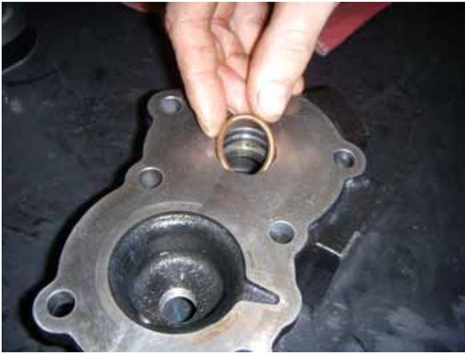
6. Instale el anillo "O" en la carcasa del cilindro de la reducción, utilizando lubricante de silicona Eaton Fuller Pieza N° 71206, o producto equivalente.
