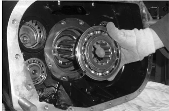
9. Remueva el manguito/espaciador del rodamiento e inspeccione por daños o desgaste.
