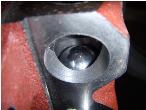
14. Instale la esfera de bloqueo de la barra de cambio en el soporte de la barra y compruebe que esté apoyado contra la barra de cambio de la 1a/2a. Compruebe que la barra de cambio de la 1/2 esté en la posición de marcha neutra.
