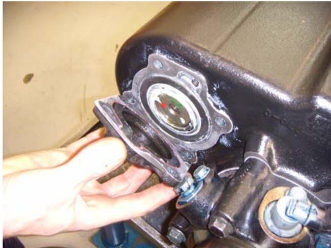
9. Instale las juntas de la tapa del rodamiento del contraeje y las tapas con el calzo especificado, determinado durante el procedimiento de calzo y apriete las tapas con 54-61 N.m [40-45 lbs.pies].
