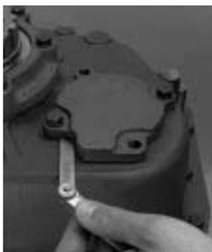
9. Localice la medición media del calibre de las láminas en el cuadro de calzos para determinar el calzo requerido y el código de color.
