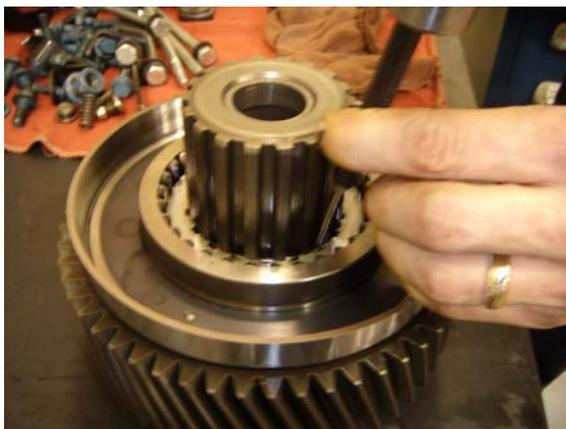
3. Desensamble el conjunto del engranaje de reducción del eje principal de la reducción, removiendo las dos espigas de retención del eje principal de la reducción del cubo del engranaje de reducción, utilizando un punzón recto de 1/8" y un martillo blando pequeño.
