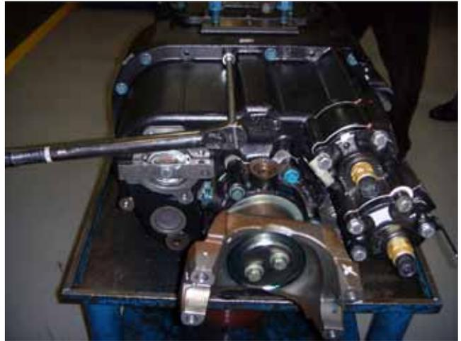
**Nota:** Los agujeros con roscados para tornillos sextavados están asentados en el área de los pernos guía de la sección auxiliar para ayudar en la separación de la junta. Inserte 2 tornillos sextavados de retención de la carcasa auxiliar en los agujeros con roscados y apriételos igualmente hasta que la junta se aparte.
