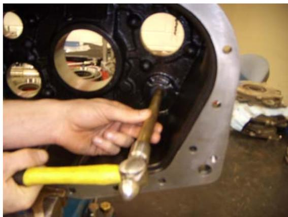
2. Cuando fuera necesario, remueva el tapón de drenaje de la carcasa auxiliar, utilizando una llave criquet cuadrada de 1/2".
