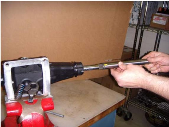
11. Remueva el eje de cambio de la carcasa del control remoto de cambio.
