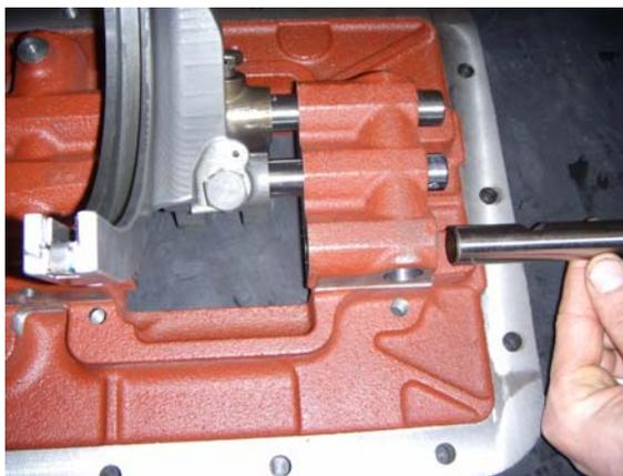
16. Cuando fuera necesario, instale la retención del cambio de la horquilla de la Reducida/Marcha Atrás.
