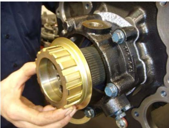
3. Si anteriormente ha sido removido, instale el anillo "O" del rotor del velocímetro sobre el eje de salida y, enseguida, instale el rotor de velocímetro sobre el eje de salida. Enseguida, instale el guardapolvo externo.
