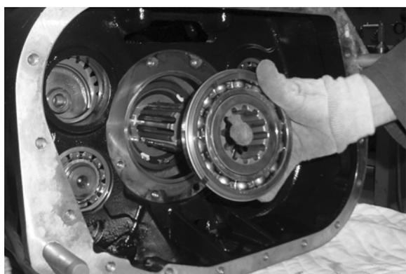
5. Instale el rodamiento auxiliar.
