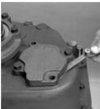
7. Utilice un calibre de láminas, lo más cerca posible de cada asiento de tornillo sextavado, y mida la holgura entre la tapa del rodamiento trasero del contraeje y la superficie de la junta de la carcasa auxiliar. Mida y apunte la holgura en dos asientos de tornillo sextavado.
