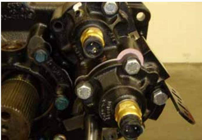
3. Remueva los 5 tornillos de retención de la tapa del cilindro de la súper reducción.
