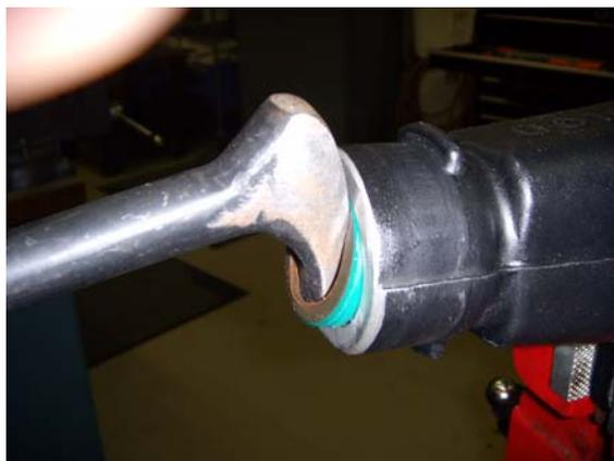
14. Cuando fuera necesario, remueva el tapón de expansión de la barra de cambio, sacándolo de la carcasa con una barra blanda y un mazo.
