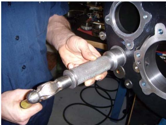
2. Cuando fuera necesario, instale el tapón de expansión del eje de la PTO con la herramienta de instalación del buje/tapón apropiado y un martillo blando.
