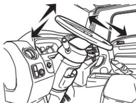
El movimiento de la columna de dirección es liberado por un cilindro neumático que, al ser accionado con una presión mínima de 6 bar, posibilita el ajuste en altura e inclinación.
