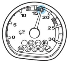
**Franja 3 – Advertencia:** Indica que el motor está entrando en rotación excesiva. Cuando el motor alcance una rotación de 2300 rpm (motor ISBe) o 2150 rpm (motor ISCe), entrará en acción el sistema de protección del motor, moderando la alimentación de combustible y la velocidad de rotación.
