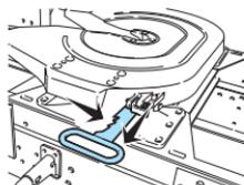
6. Trabe la palanca y retire el camión.
