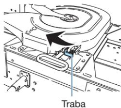
5. Tire la palanca hacia la derecha y luego hacia afuera.
