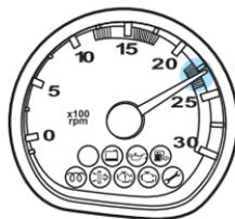
**Franja 4 – Roja:** Indica rotación excesiva. En desaceleraciones y al transitar en declives, accione una marcha compatible y use el freno motor y/o el freno de servicio para controlar la velocidad de rotación del motor.
