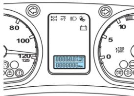
**1. Odómetro total:** indica la distancia total recorrida por el vehículo. Indicación máxima 9.999.999 km. Indica la misma información mostrada en el tacógrafo.
