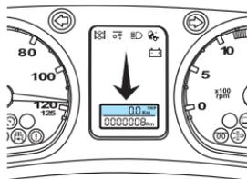
**3. Reloj:** indica el horario en el formato de 24 horas y es comandado por el tacógrafo. El ajuste de la hora es efectuada en el tacógrafo.
