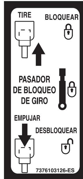
El control del pasador de bloqueo de la plataforma de giro (67) se encuentra a un lado de la consola delantera, en el lado derecho de la cabina. La grúa tiene un control tipo empuje/tiro.
