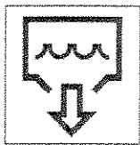
Vaciado de depósito de agua
