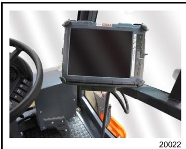
Die Verdichtungs- und Positionsdaten werden kombiniert und visuell aufbereitet. Eine flächendeckende Dokumentation und Auswertung ist somit noch während der Verdichtung möglich.
