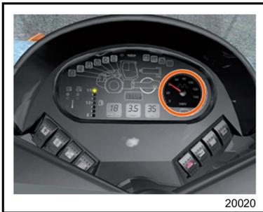
Der aktuelle HMV-Wert wird dem Bediener auf dem Armaturenbrett entweder mit einem analogen Rundinstrument oder in einer Balkendarstellung angezeigt (siehe Handbuch der jeweiligen Maschine).
