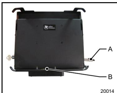
1. Repousser vers le bas le levier de blocage [A] sur le support de véhicule.
