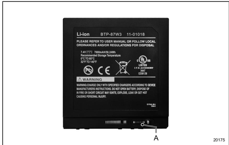
**i** Suite à une longue période d'immobilisation, raccorder le Panel PC avant l'utilisation sur chantier à une alimentation électrique externe durant la nuit pour charger entièrement l'accu.
