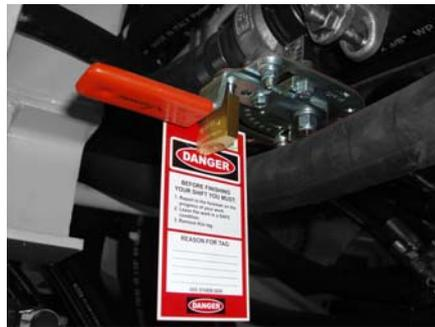
Abbildung III - 4: Hydraulischer Wartungsschalter
