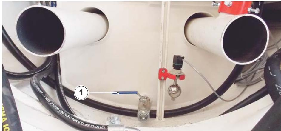
Abbildung IV - 10: Ölablass am Öltank
