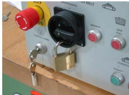
Abbildung III - 3: Wartungsschalter mit Schloss
