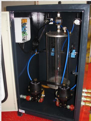
**DOSIFICADOR DE ADITIVOS DA 20** (opcional) capaz de dosificar hasta 2 aditivos por suma de los mismos, en un vaso de 18 lts. Sistema presurizado de descarga automática por el fondo del vaso a presión. Carga individual con 2 bombas centrífugas independientes. Circuito de lavado con bomba de agua independiente.
