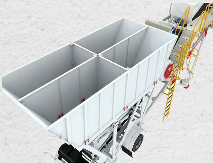
**Báscula dosificadora de áridos** para pesaje por suma de los mismos, montada sobre cuatro celdas de carga de 4000 lbs (4 x 4000 lbs) dimensionada para una capacidad máxima de 4500 Kgs de áridos en total. Descarga por el fondo mediante una compuerta de apertura regulable y comandada por un cilindro neumático de Ø63 x 100 mm de carrera marca Festo y un vibrador eléctrico.
