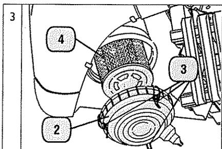
**Atenção!** A operação descrita deve ser efetuada respeitando o plano de manutenção, ou casualmente, se acender no painel a luz indicadora de filtro de ar saturado.
