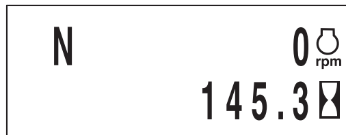
Pantalla de rpm del monitor de pantalla estándar (SDM)
