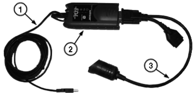
Cables para la conexión de SERVICE ADVISOR
