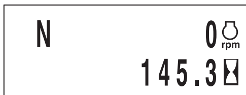
Indicador de transmisión, tacómetro y horómetro
