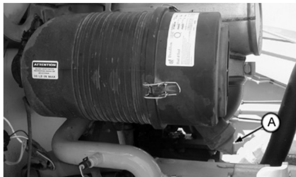
A—Válvula de descarga de polvo del filtro de aire del motor
