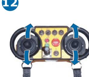
Mit beiden Fahrhebeln Fahrwerkketten in Bewegung versetzen.
