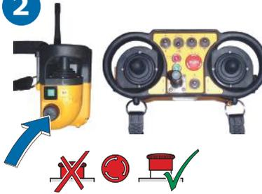
Funkfernsteuerung einschalten, NOT-Halt entriegeln.
