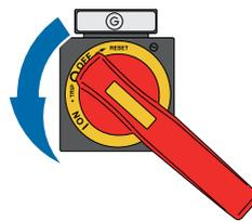
Hauptschalter in Richtung RESET und anschließend auf ON drehen.
