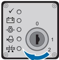
Zündschlüssel auf START-Stellung drehen und halten, bis der Dieselmotor läuft.
