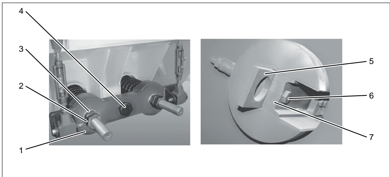
Abb. 4.89: Sustitución de las placas distanciadoras
