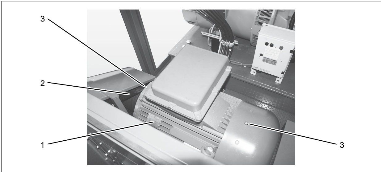
Abb. 4.79: Lubricación del motor eléctrico
