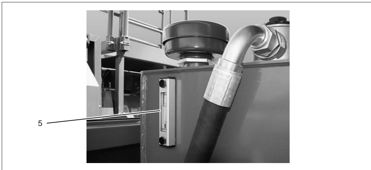
Abb. 2.43: Depósito hidráulico (II)
