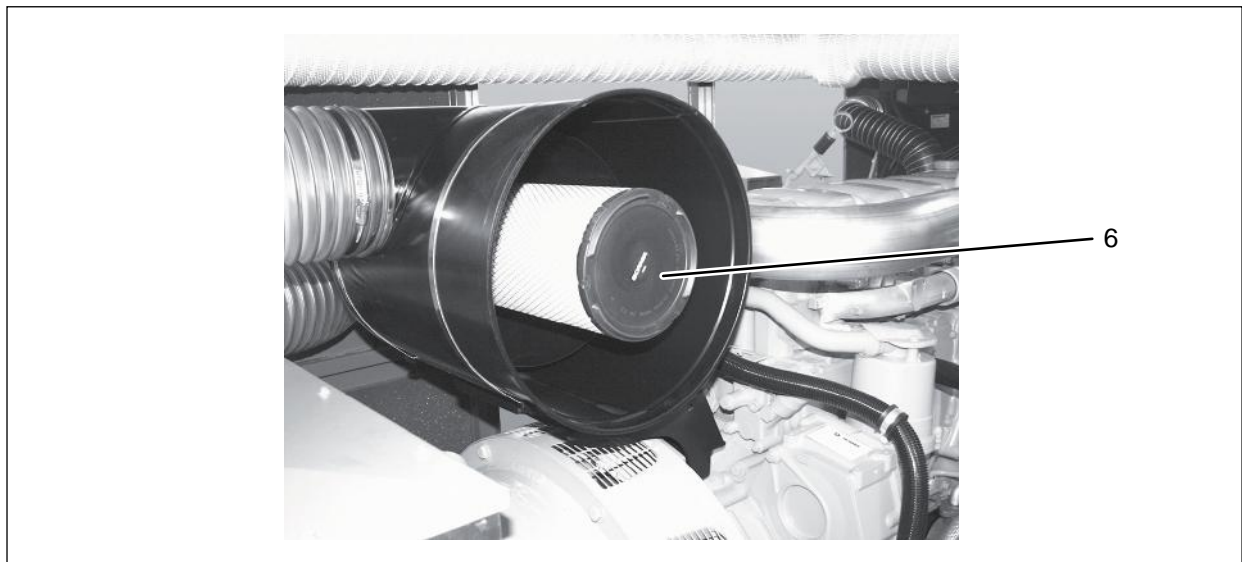
Abb. 4.9: Sustituir el elemento filtrante de seguridad
