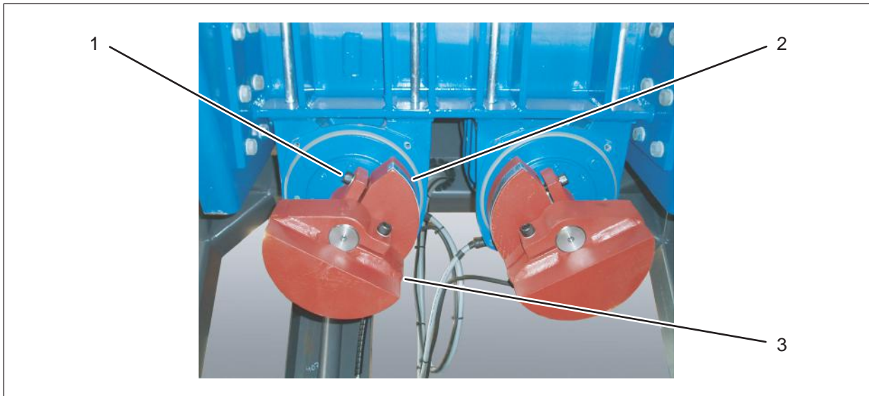
Abb. 4.71: Pesa de desequilibrado del alimentador vibratorio
