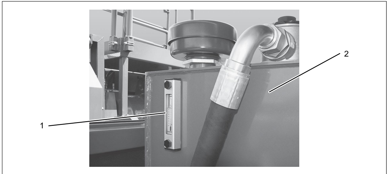
Abb. 4.11: Nivel de llenado del depósito de aceite hidráulico
