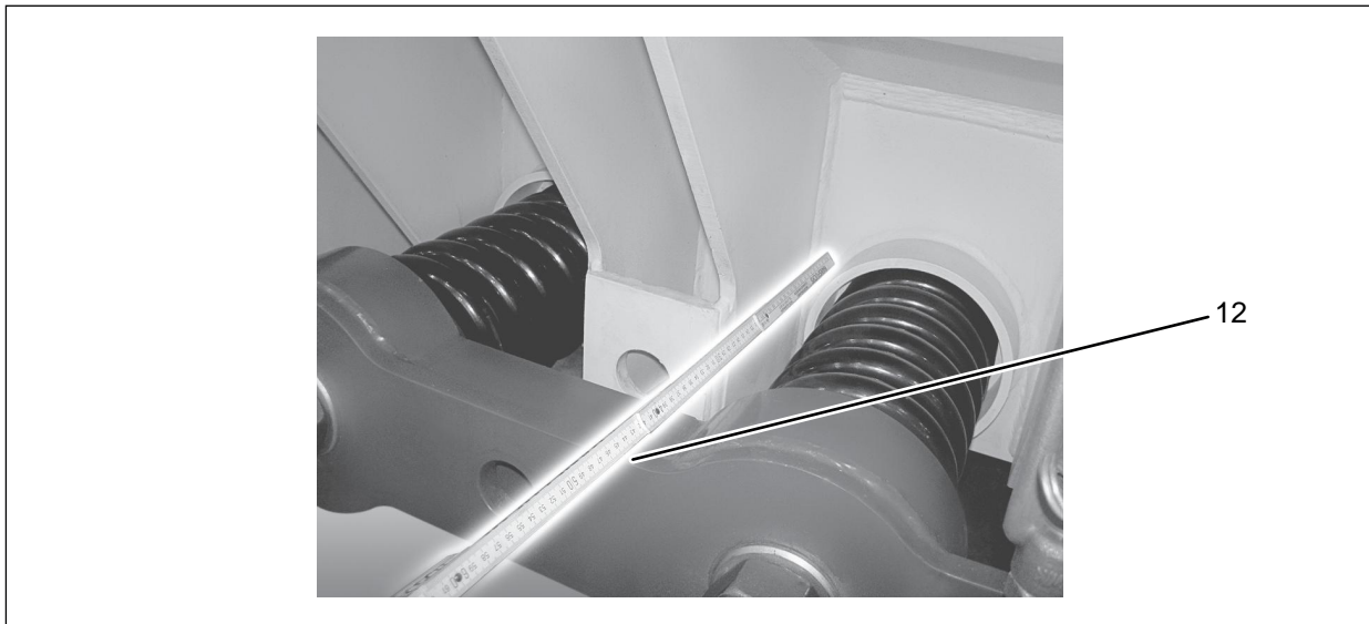
Abb. 4.88: Comprobar la tensión previa de los resortes
