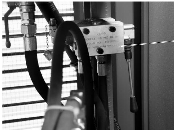
① Steuerblock Brecher: Spaltverstellung Valve block crusher: gap setting
