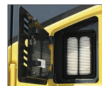
Filtro de aire externo del acondicionador de aire
