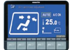
La función de control de dos niveles mejora el flujo de aire y mantiene al operador cómodo en todas épocas del año. La función de desescarchador mantiene el vidrio limpio.
