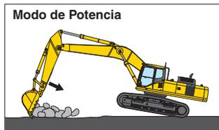
Fuerza de empuje del aguilón es incrementada, operaciones de excavación y zanqueo en terrenos duros se han mejorado.
