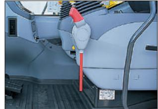
*Palanca de Bloqueo en Posición Bloqueada*
