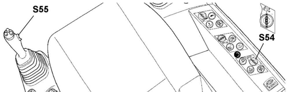
**Fig. 3-89** Desbloquear desconexión de movimientos de equipamiento
