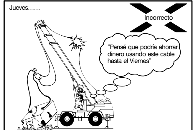
Figura 1–26 No opere la grúa con un cable gastado o dañado.
