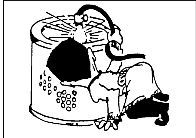
Figura 2–19 Inspección del Elemento del Filtro de Aire
