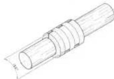
7. Verifique si el eje puede ser girado después el montaje de cada anillo, coloque lo aprieta-empaquetadura prensando el último anillo, apriete las tuercas con las manos y gire el eje para certificarse de que él no cuesta en lo aprieta-empaquetadura.
