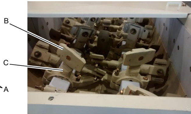
Fig. 1: Braços e palhetas do misturador / Arms and paddle tips of the mixer
