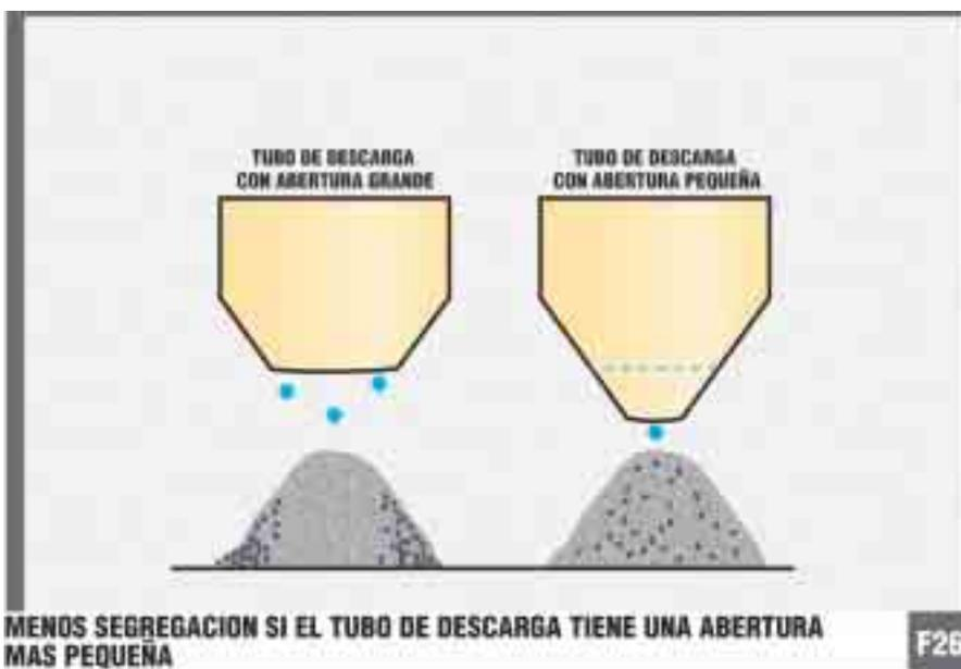
b. El dosificador debe cargarse directamente en su parte central y el material que proviene del tubo para cargar el dosificador no debe viajar en trayectoria horizontal (vea las Figuras 24 y 25). Además, cuando la mezcla se descarga a través de un tubo de descarga, si éste tiene una abertura pequeña se reduce la segregación al mínimo (vea la Figura 26). Recuerde, si el material se segrega en el dosificador, quedará segregado en toda la tolva.
