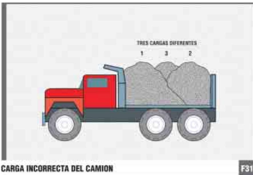
La descarga rápida de materiales del camión llena la tolva de la pavimentadora y reduce al mínimo el escurrimiento del material que frecuentemente se produce en la compuerta trasera del camión. La descarga rápida evita la acumulación de los materiales gruesos en la porción exterior de las secciones laterales de la pavimentadora.
