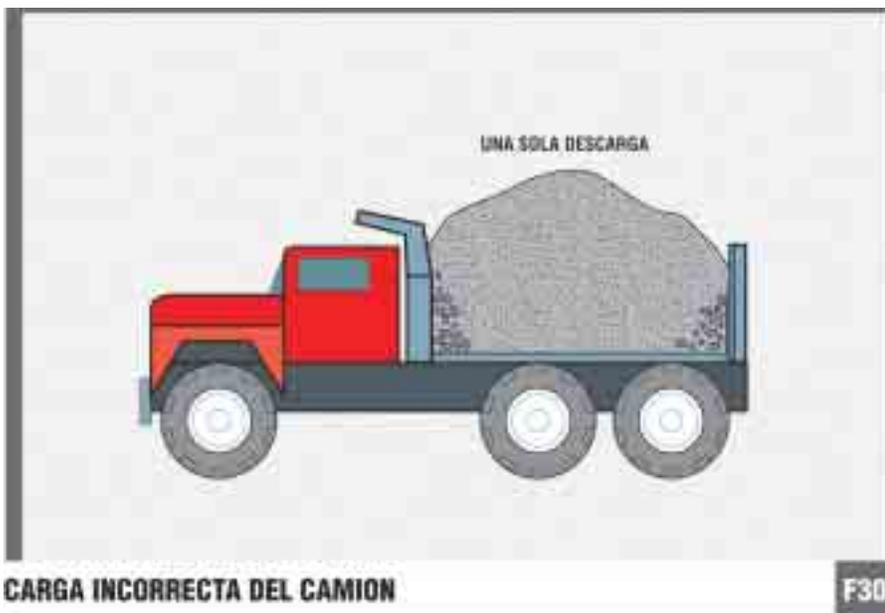
Al cargar el camión en tres etapas diferentes de descarga, la primera cerca de la parte delantera de la caja del camión, la segunda cerca de la compuerta trasera y la última en su parte central, el material grueso es forzado a rodar hacia el centro del camión para luego quedar cubierto como se ilustra en la **Figura 31**. Esto asegura que el primer material descargado por el camión será material de buena calidad con el material grueso combinado en su parte central.
