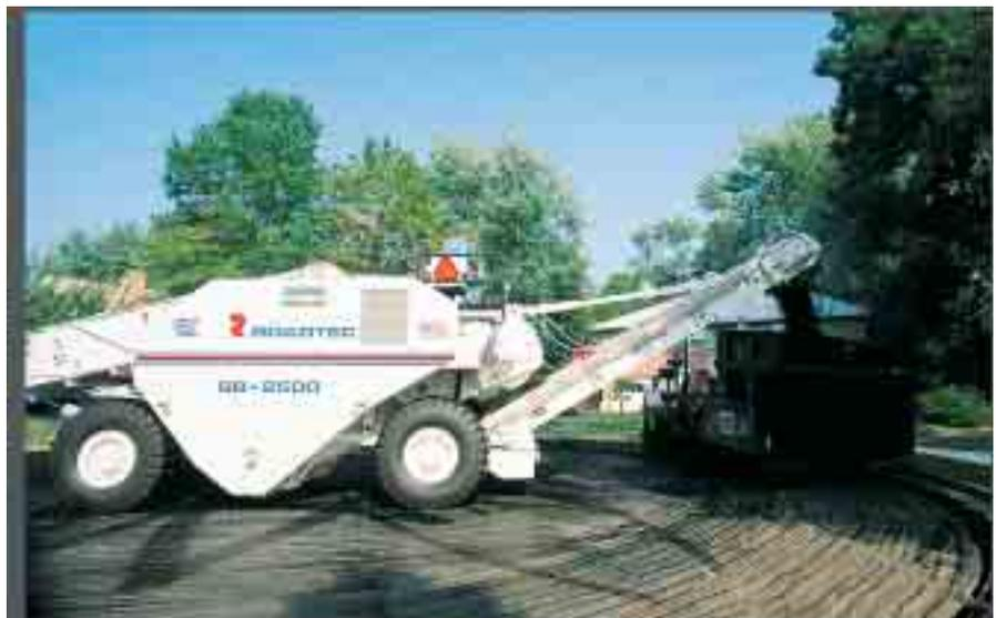
**EL SHUTTLE BUGGY® PERMITE UNA MAYOR MANIOBRABILIDAD DE LA PAVIMENTADORA**
