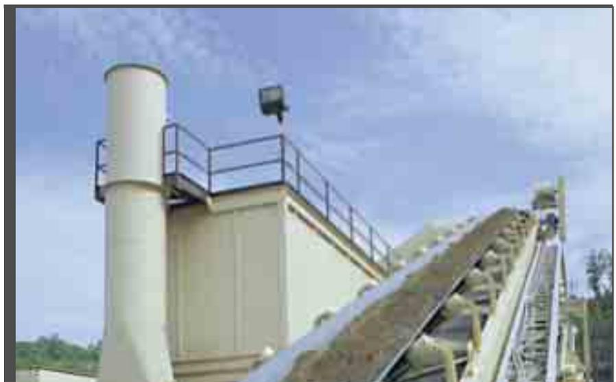
**CAMARA DE FILTROS CON TUBO DE DESCARGA CON GAS DE ESCAPE TRANSPARENTE**
