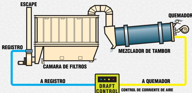
EL CONTROL DE LA CORRIENTE DE AIRE DEL QUEMADOR ES ESENCIAL PARA IMPEDIR UN FLUJO DE AIRE EXCESIVO HACIA LA CAMARA DE FILTROS
