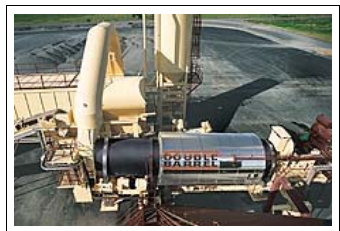
Fig. 3.4.18 Planta continua con tambor secador-mezclador Double Barrel (Fuente: ASTEC < www.astecinc.com >)
