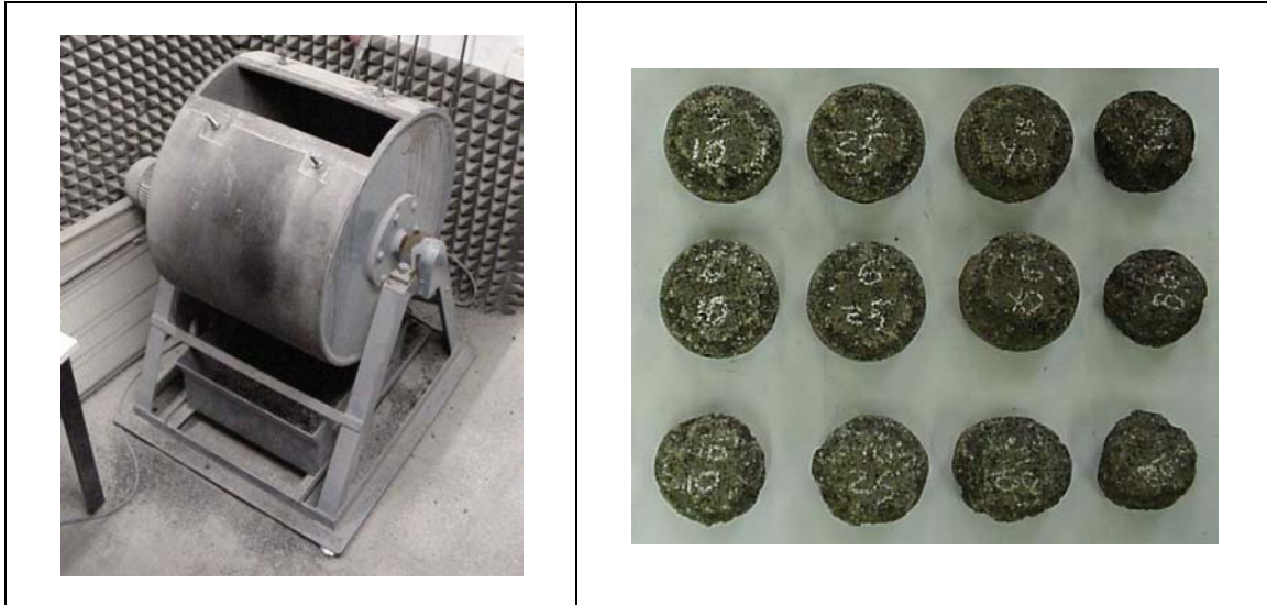
Fig. 4.7.2 Máquina para el ensayo de Los Ángeles y probetas ensayadas mediante el método UCL ®
