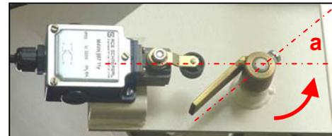
Quando a haste for empurrada, é porque o apalpador está sendo pressionado pelo fluxo de material, abrindo então o circuito do fim-de-curso, desacionando assim os vibradores.
