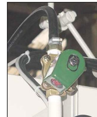
Válvula solenóide controladora do fluxo de ar
