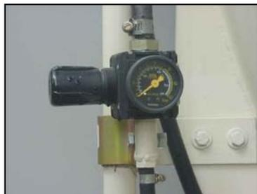
Válvula para regulagem da pressão de entrada do ar comprimido.
