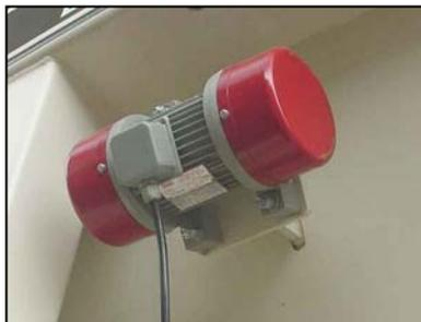
O vibrador tipo carrapato está afixado em um suporte externo ao dosador.
