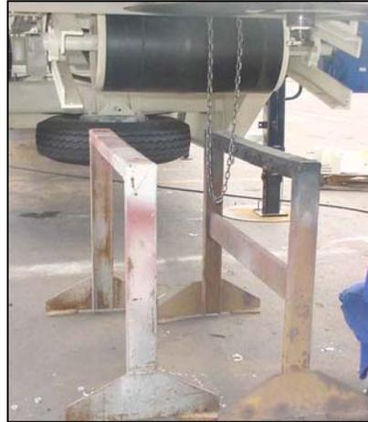
Coloque a calha vibratória na posição:
