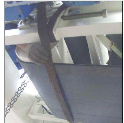
Antes de iniciar o levantamento da correia com a talha para desapoia-la da viga (V), solte o suporte intermediário que sustenta a correia, que a prende lateralmente ao chassi do equipamento. No suporte frontal, apenas afrouxe os parafusos de fixação. Certifique-se que a correia esteja firmemente sustentada pelo conjunto da talha.
