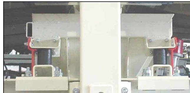
Retire as travas da moega (peças pintadas em vermelho). Guarde estes dispositivos para quando for transportar o equipamento.
