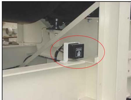
Localización del sistema de liberación en el chasis del secador.
