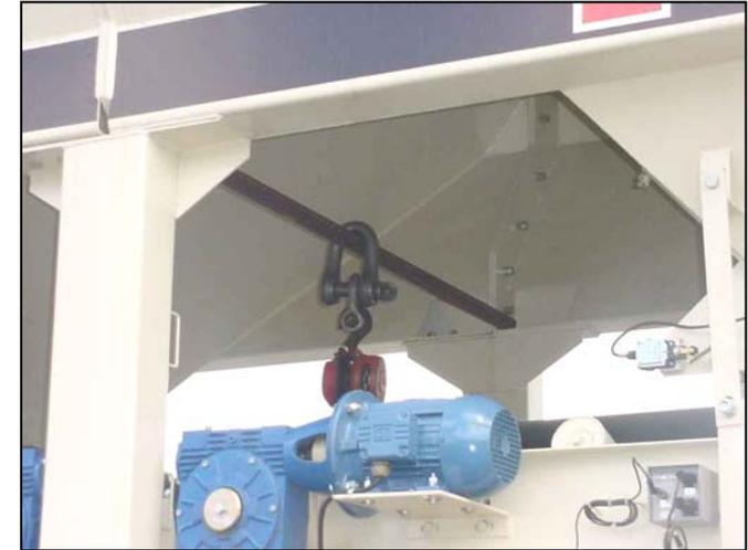
Passa a cinta de levantamento na extremidade inferior da correia. (Cuidado para não danificar a esteira).
