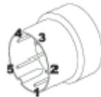
**Conectores dos cabos (13): da saída de sinal (0 a 5 Vcc) dos transdutores/amplific. MXT-100**
