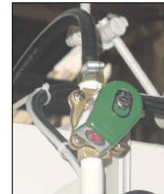
Válvula solenóide controladora do fluxo de ar
