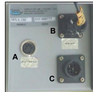
A – Conexão de entrada: é por onde entra o sinal emitido pela célula de carga.
