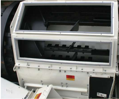
Cámara de mezcla
