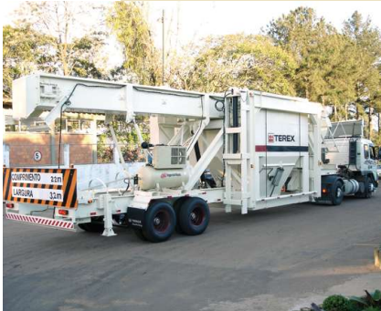
silo móvil autoelevable 25 m 3
