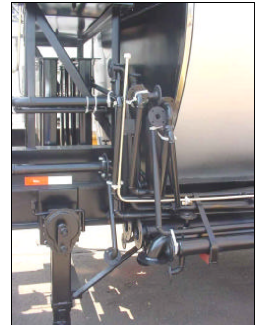
Tubulações de interligação da tancagem.
