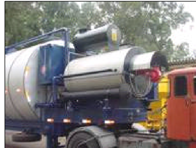
Aquecedor incorporado em sistema de tancagem móvel
