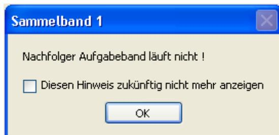
Debe tenerse en cuenta que únicamente pueden conectarse cintas si la siguiente cinta en el flujo de material ya está conectada. De lo contrario se emite un mensaje de error.
