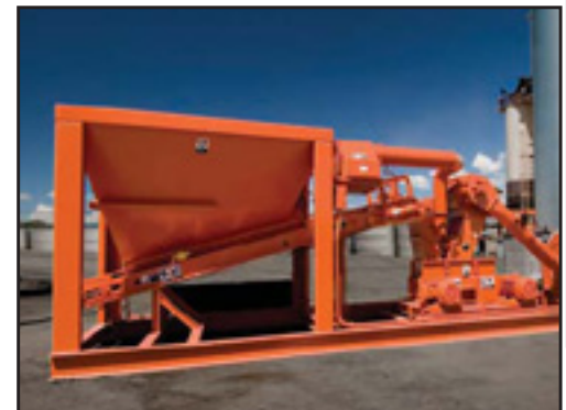
El depósito con la preparación de carbón pulveriza el carbón que se usará en el quemador.
