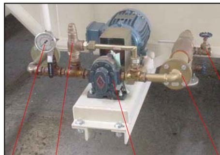
La función de esta bomba (Pos.1) es la de bombear el aceite combustible bajo presión a la punta del atomizador del quemador. La presión del fluido se controla por una válvula de alivio (Pos.2) y monitoreada por un manómetro (Fig.3), colocado en la línea de presión, que ya viene regulada de fábrica para permitir que la bomba suministre una presión de 6 kaf/ cm<sup>2</sup>.
