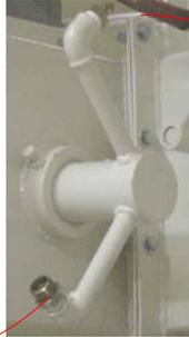
Entrada de aire para la punta del atomizador.
