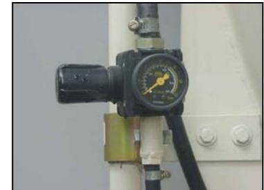
Válvula para regulado de la presión de entrada del aire comprimido.
