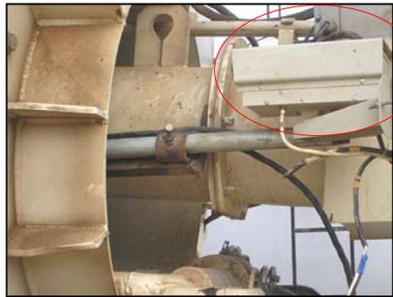
Cámara instalada junto al quemador para visualizar el fuego.
