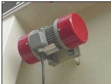
El vibrador tipo garrapata está fijado en un soporte externo al alimentador.
