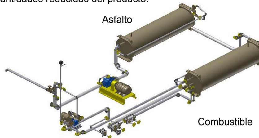
El Rectificador de temperatura (o cambiador de calor), se utiliza en la línea de combustible de quemadores de plantas de asfalto, para calentarlo a la temperatura en que proporcionará las condiciones ideales de quema.
