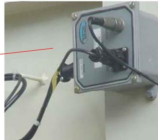
Transductores MXA100 p/ celdas de carga de las cintas dosificadoras.
