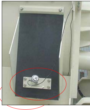
Sensor PT-100, localizado en la caja de descarga de material del secador
