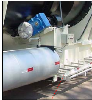
Escaleras de acceso p/ mantenimiento de las válvulas del filtro en posición de transporte.
