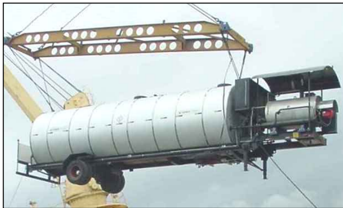
Con utilización de spreader .
