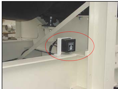
Localización del sistema de liberación en el chasis del secador.
